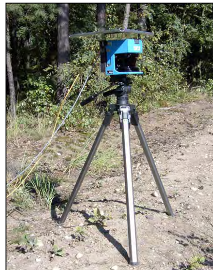
Bild 34: Laserscanner, Typ SICK LMS 200
