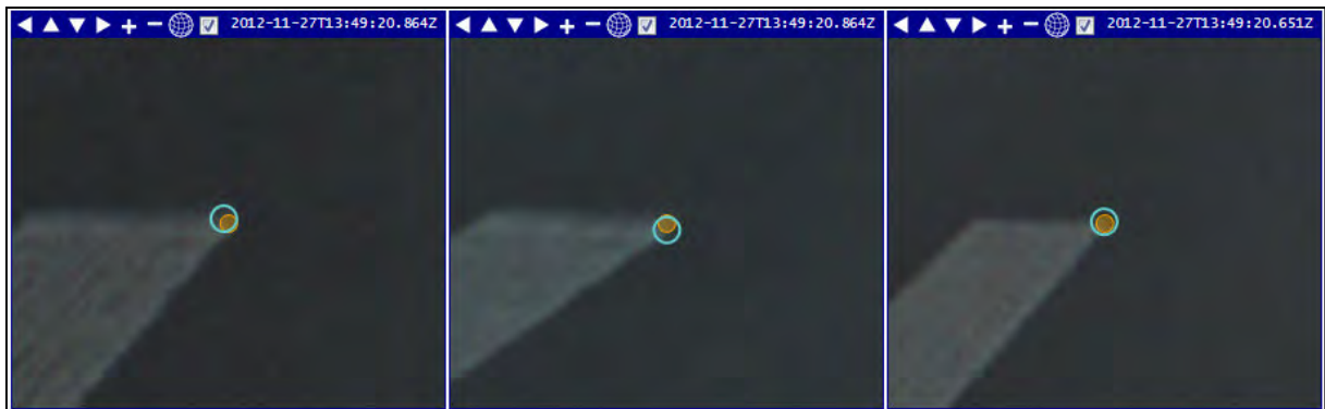
Bild 29: fotogrammetrische Erfassung von Randmarkierungen des Verkehrsraums
