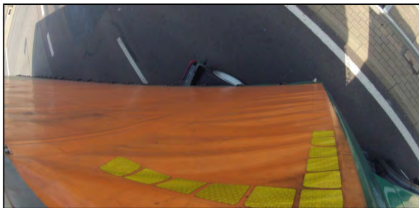
Bild 52: Ausschwenken des Sattelauflieger beim Referenz-Lkw
