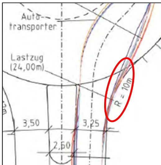
Bild 15: Überstreichung Eckausrundung Typ 5 (FRIEDRICH U.A. 2013)
