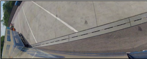
Bild 75: Überfahren des Nachbarparkstand mit den hinteren Achsen
