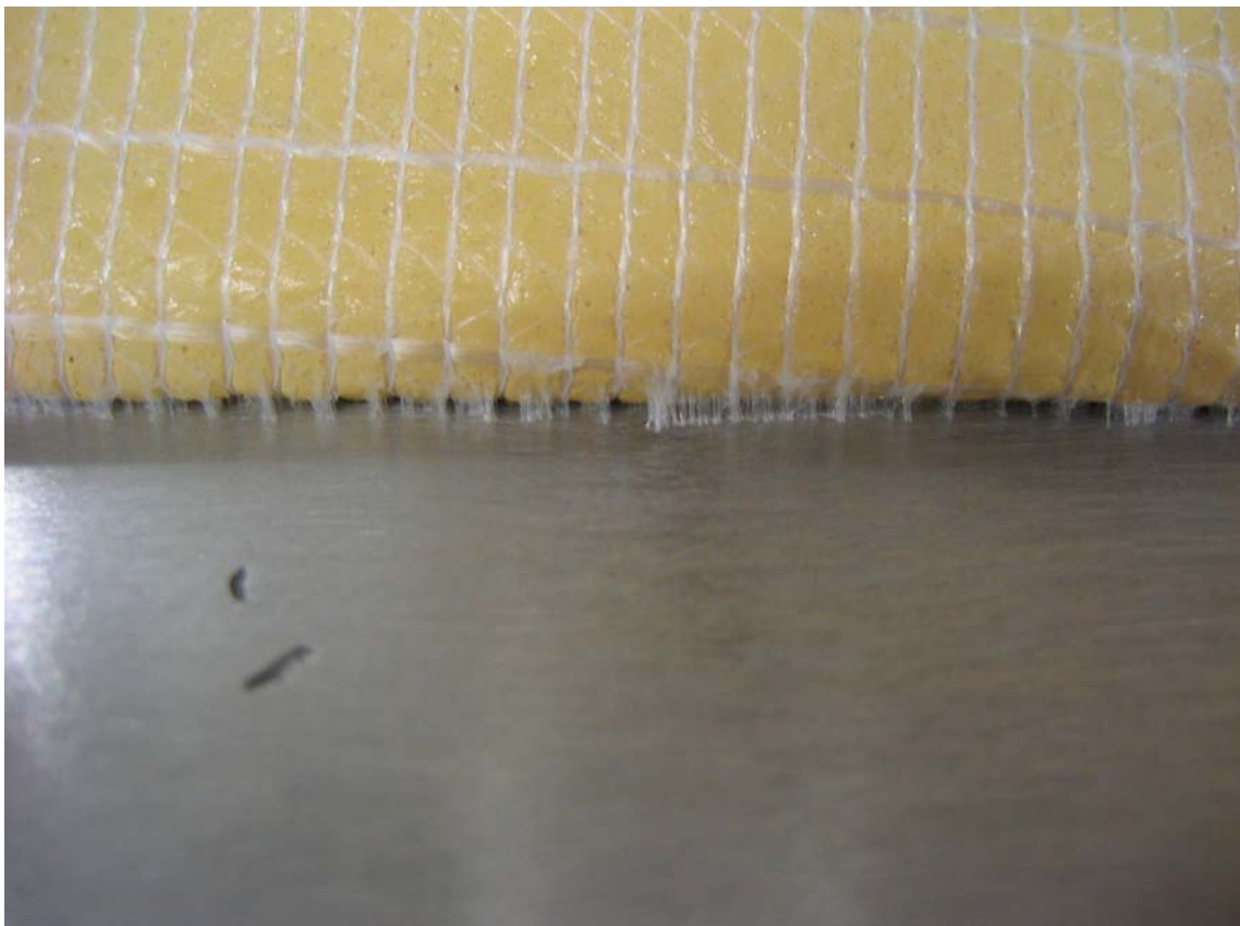
Bild 20: Folie C während des Ablösevorgangs von der Aluminiumoberfläche
