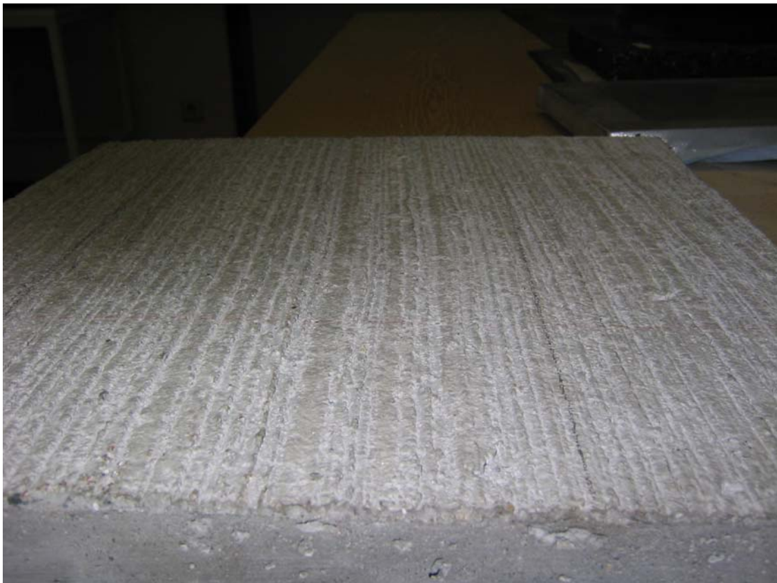
Bild 6: Probekörper aus Waschbeton
