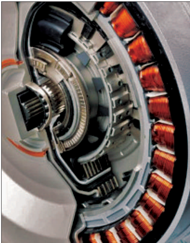
Bild 2: Elektromotor/Generator Hybridgetriebe © Getrag Ford
