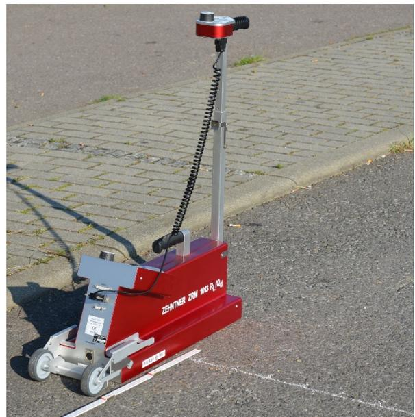
Abbildung 41: Messaufbauten bei den in situ-Messungen kleiner Teilflächen (oben: für  $p_{d/45}$ ); unten: für  $R_L/Q_d$ )
