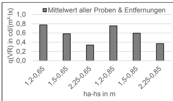
Abbildung 26: Mittelwert Leuchtdichtekoeffizient  $q(VR)$  nach Augpunkthöhe des Beobachters ( $ha$ ) und Scheinwerferhöhe ( $hs$ )
