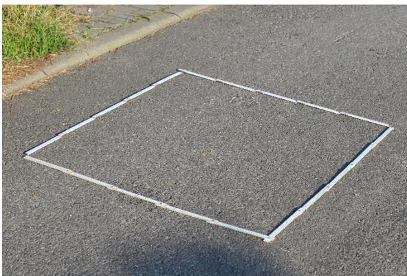
Abbildung 40: Umriss einer kleinen Teilfläche für die in situ-Messungen
