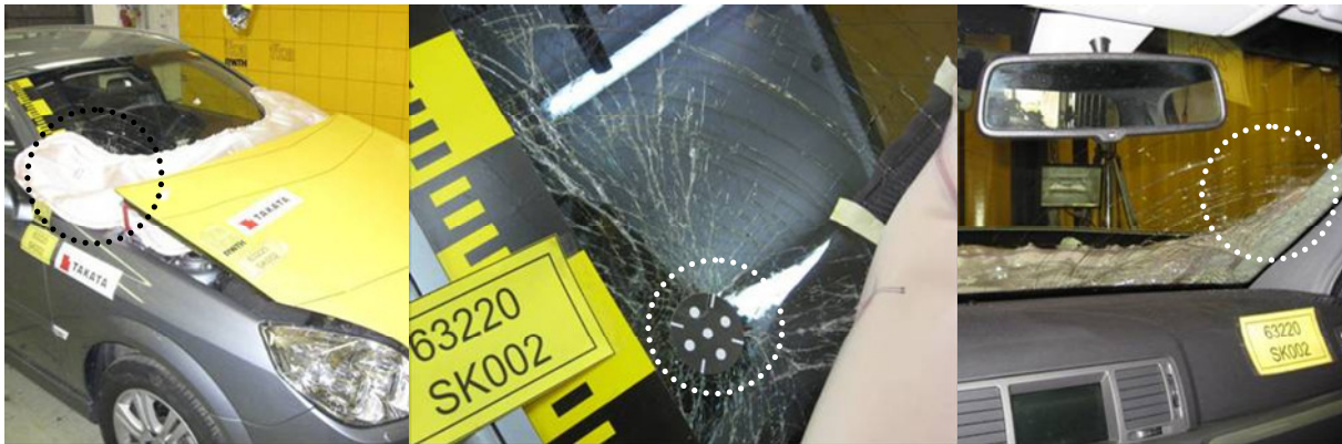
Abb. 5-52: Ansichten nach dem Airbagtest im A-Säulenbereich
