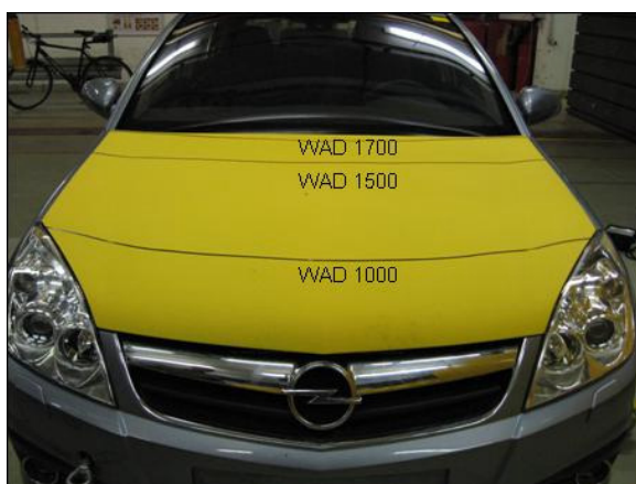
Abb. 5-12: Versuchsfahrzeug inkl. Airbag und Motorhaube
