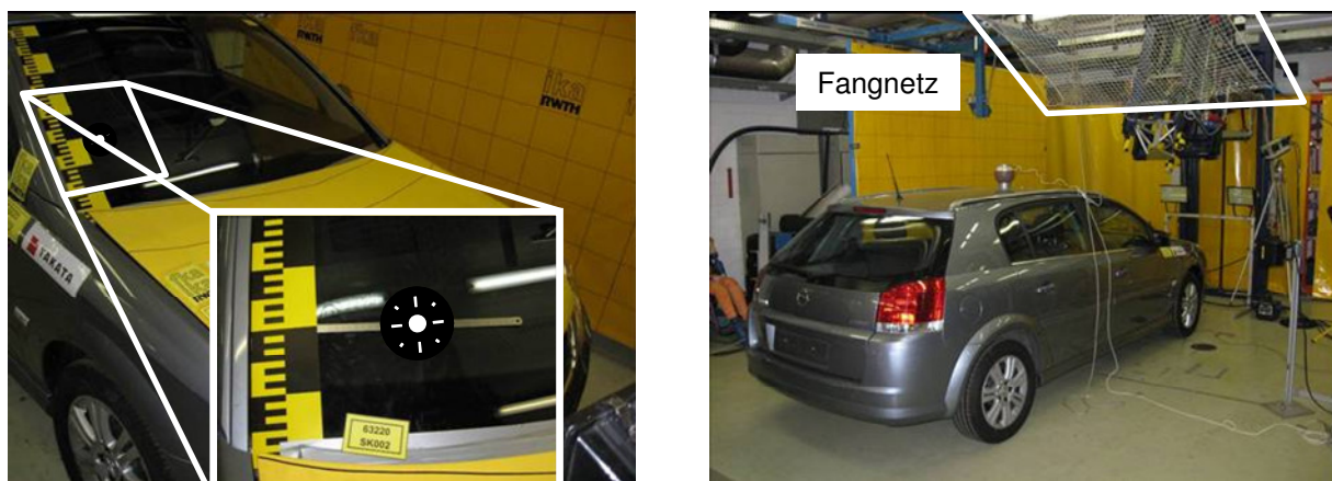
Abb. 5-42: Versuchsaufbau – Airbagtest im A-Säulenbereich
