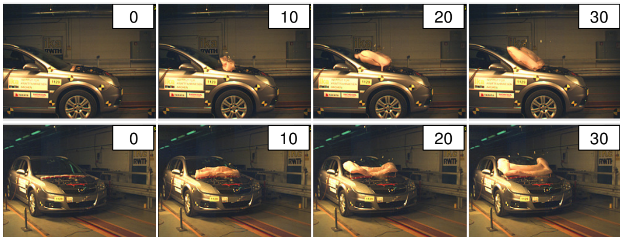
Abb. 10-22: Auslöseverhalten Airbagsystem ohne Haube, t in [ms]
