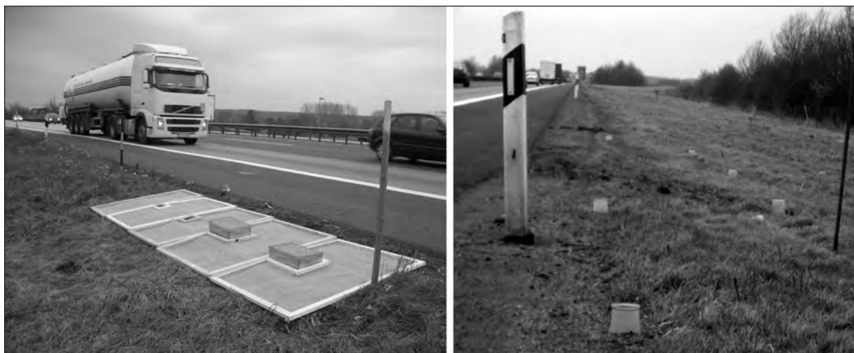
Bild 33: links: Bergerhoffgefäße und Edelstahlkisten mit Umbau (technische Glaskugeln auf Kunststoffnetz); rechts: Bergerhoffgefäße in 10 cm Höhe im Gras ohne Umbau
