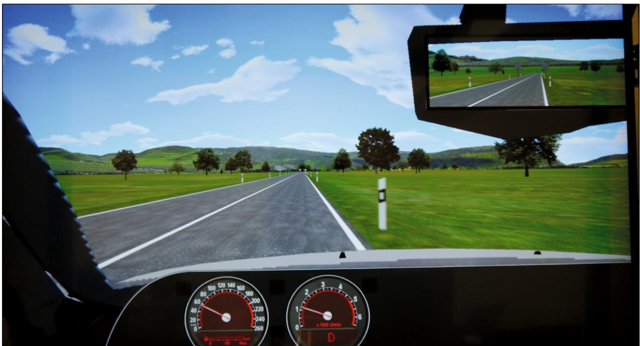
Bild 3-3: Implementation der Prüfstrecke in den Kompaktsimulator. Rückspiegel, Tacho und Drehzahlmesser sind in die Szenerie eingeblenndet.
