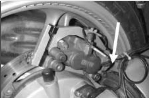
**Bild 17:** Bremsmomentmesseinrichtung hinten mit Blattfedern und Kraftmessdose (s. Pfeil)
