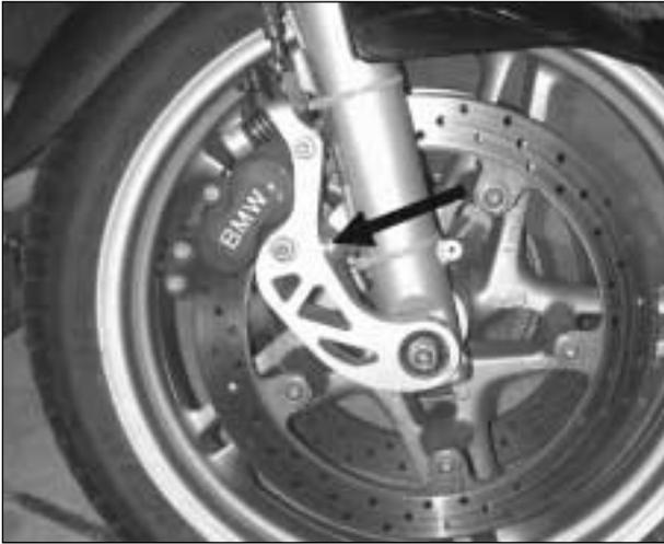
**Bild 16:** Bremsmomentmesseinrichtung vorne mit Kraftmessdose (s. Pfeil)
