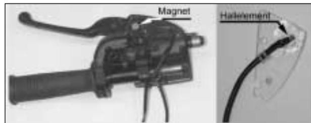
**Bild 19:** Sensor zur Ermittlung des Hebelbetätigungswinkels: links Einbauposition des Magneten, rechts Abdeckplatte mit Hall-Element
