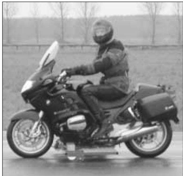
Bild 11: Versuchsfahrzeug BMW R 1150 RT mit integrierter und abgedeckter Messtechnik
