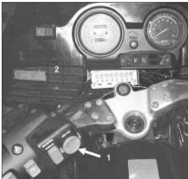
**Bild 12:** Blick ins Cockpit des Versuchsmotorrads: Bremsystemumschaltung (1) und Informationsdisplay für den Versuchsfahrer (2)
