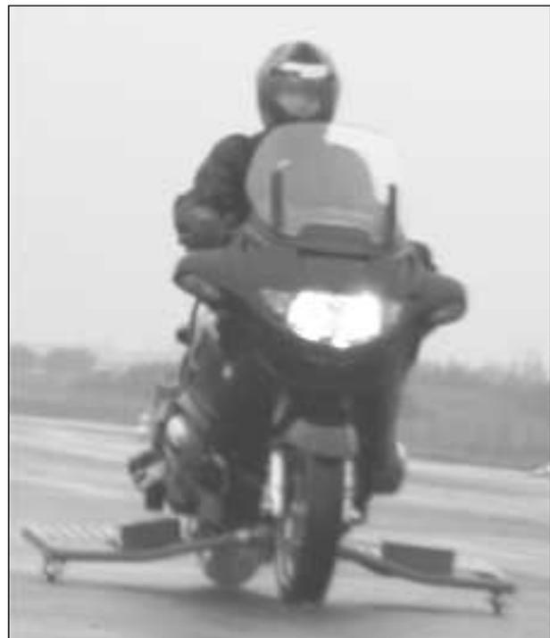
**Bild 20:** Versuchsfahrzeug mit Umsturzvorrichtung
