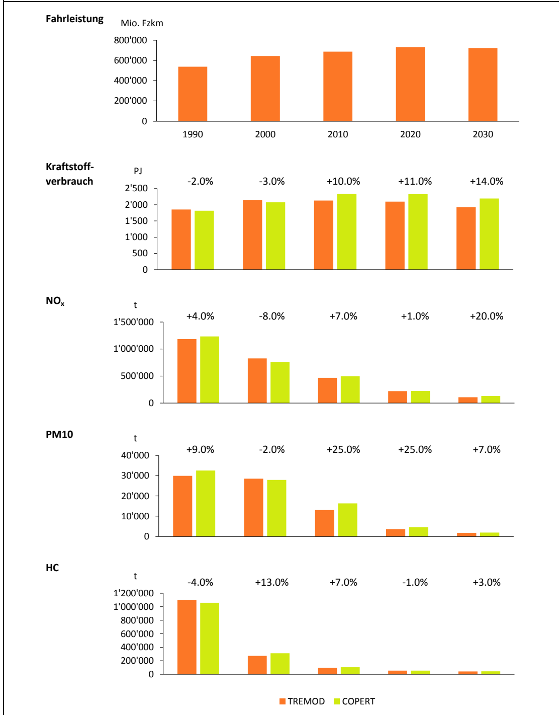
Abbildung 26: Fahrleistungen und Emissionen von COPERT und TREMOD unter Verwendung gleicher Inputdaten, Zehnjahresschritte 1990-2030 (nur PKW, LNF und SNF). Die Abweichungen in % beziehen sich auf den jeweiligen TREMOD-Wert (also COPERT-Wert/TREMOD-Wert – 100%).
