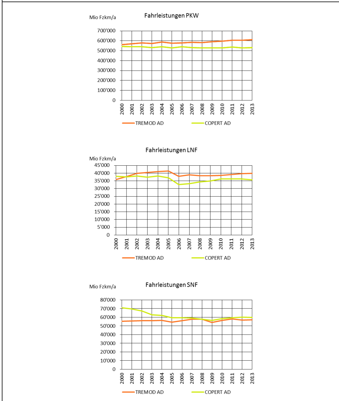
Abbildung 12: Vergleich der Ex-Post-Fahrleistungen gemäß TREMOD- und COPERT-Aktivitätsdatensätzen.
