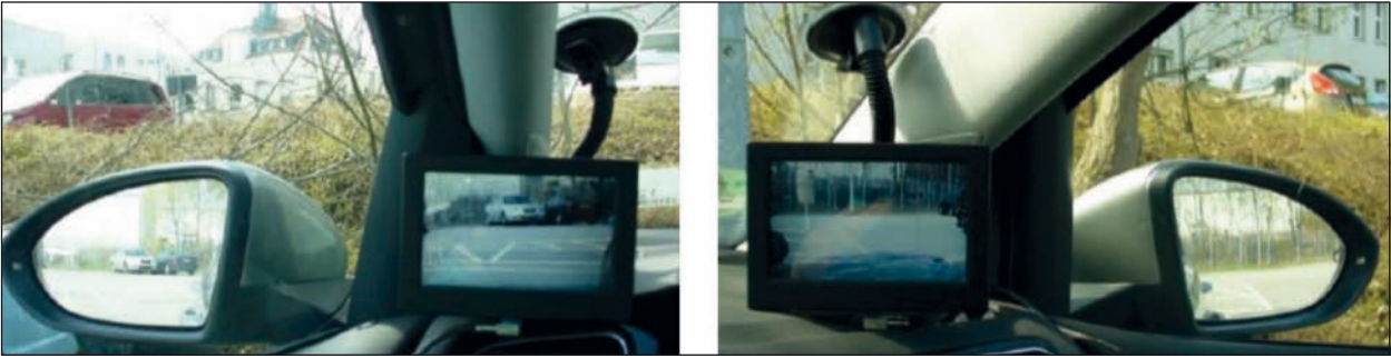
Bild 6: Integration der Monitore neben der A-Säule (Position KMS 3)
