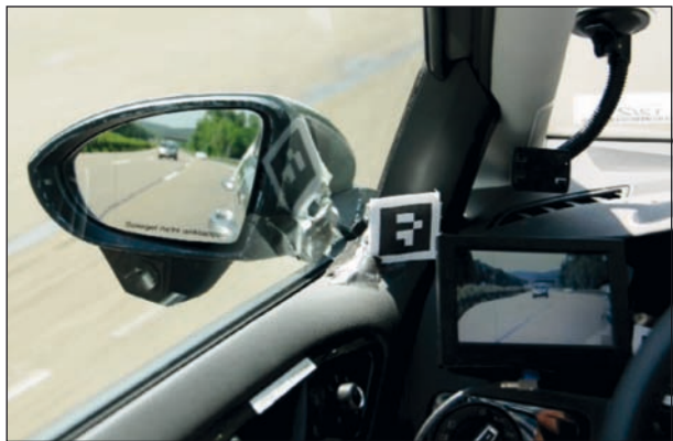
Bild 18: Schlecht wahrnehmbares Fahrzeug im Hintergrund (weißes Fahrzeug auf beigefarbener Betonfahrbahn)
