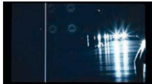
Bild 35: Monitor im Abstand von 50 m und eingeschaltetem Fernlicht
