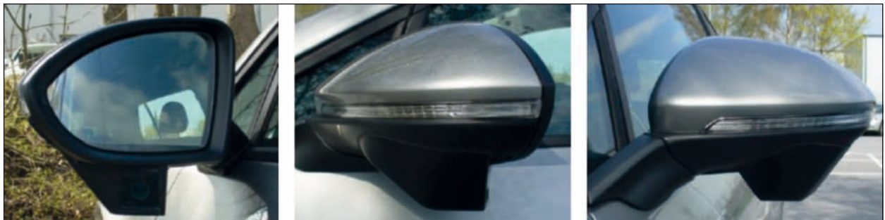
Bild 3: Linker Außenspiegel mit montierter Kamera am Spiegelgehäuse
