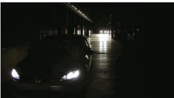
Bild 32: Versuchsaufbau: Nachfolgendes Fahrzeug im Abstand von 50 m mit eingeschaltetem Abblendlicht
