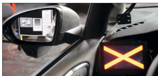
Bild 41: Bildausfall durch elektromagnetische Strahlung
