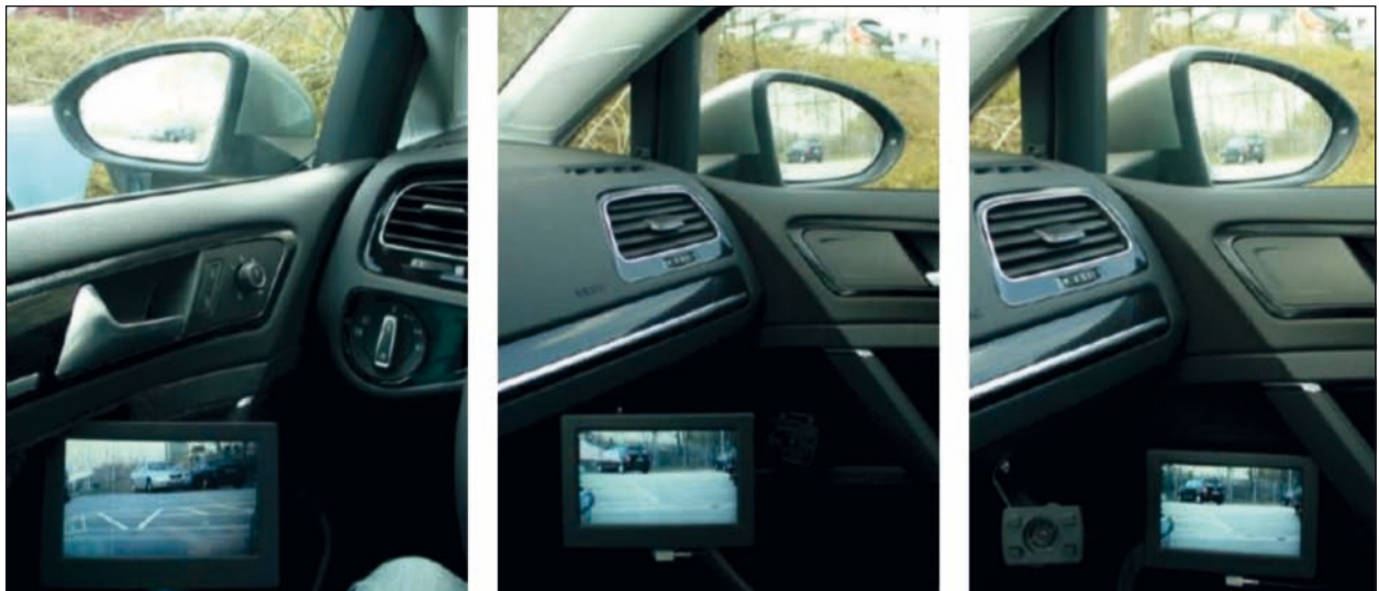
Bild 4: Integration der Monitore in der Fahrer- und Beifahrertür (Position KMS 1)
