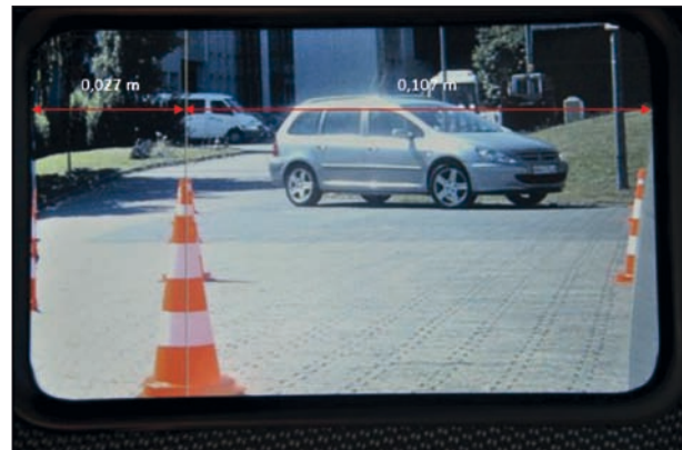
Bild 13: Sicht im Monitor mit lateralen Abmaßen des Monitors
