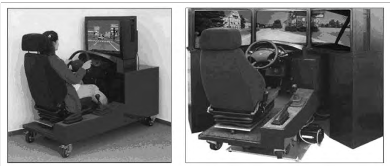
Bild 16: Fahrsimulator ohne Bewegungssystem mit einfachem Monitor (links) sowie Fahrsimulator mit einfachem Bewegungssystem und dreifachem Bildschirm (rechts) aus dem Projekt TRAINER (BATEN & BEKIARIS, 2003)
