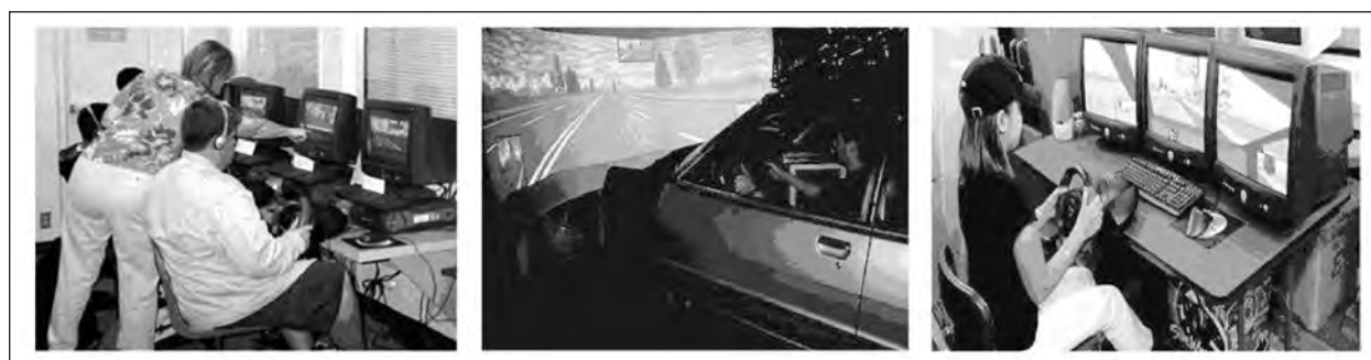
Bild 14: Die drei unterschiedlichen Simulationsanwendungen (links: Fahrstand mit Monitor, Lenkrad, Pedalerie; Mitte: Fahrsimulator mit Projektionsleinwand; rechts: Fahrstand mit drei Monitoren, Lenkrad, Pedalerie) aus der Studie von ALLEN et al. (2003)
