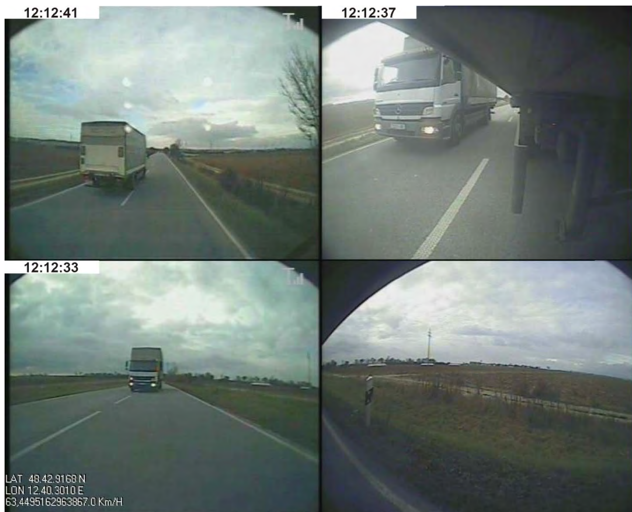
Bild 10: Beispielbilder der am (Lang-)Lkw angebrachten Kameras. Links oben Frontkamera, links unten Heckkamera, rechts Seitenkameras (Spedition A)
