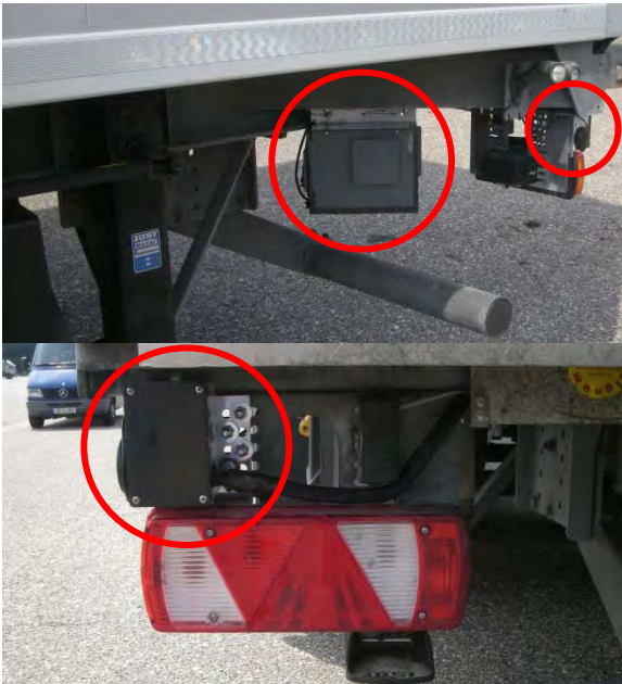
Bild 6: Oben: Anbringung der Aufzeichnungsbox sowie Radarbox mit GPS-Empfänger am Fahrzeuganhänger; unten: Ansicht der Radarbox, die über der linken Heckleuchte angebracht wurde (Spedition A)
