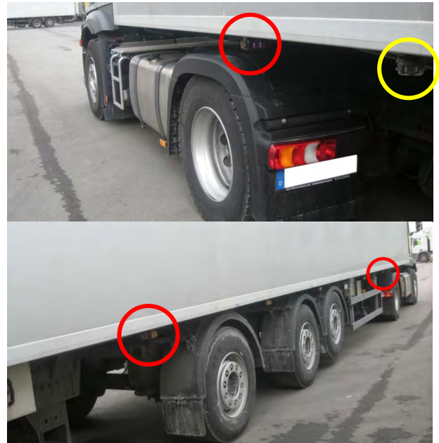
Bild 8: Anbringung der Seitenkameras (roter Kreis) sowie die standardmäßig installierte Seitenkamera (gelber Kreis) am Auflieger (Spedition A)
