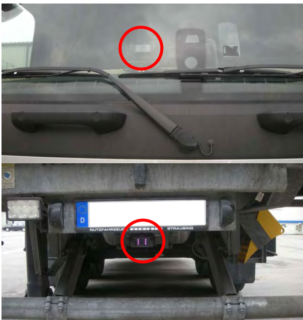
Bild 7: Oben: Position der Frontkamera; unten: Position der Heckkamera (Spedition A)
