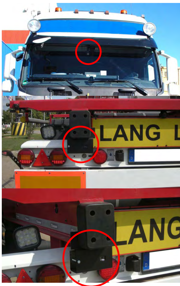
Bild 9: Oben: Position der Frontkamera; mittig/unten: Position der Heckkamera (Spedition B)
