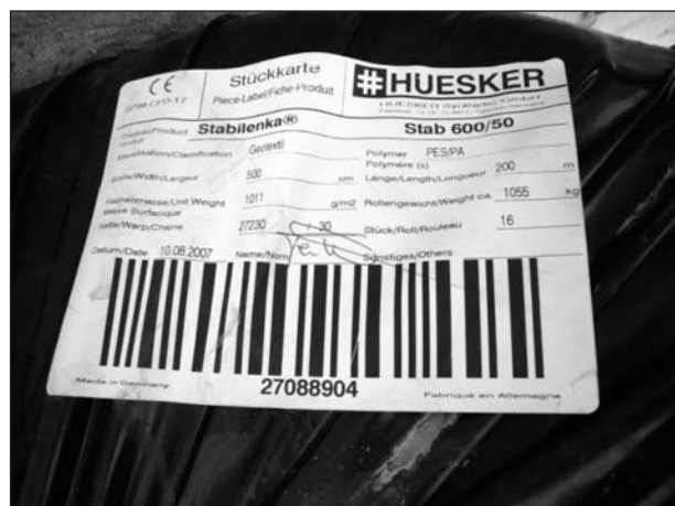
Bild 1: Rollenetikett eines Geokunststoffs
