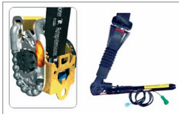
Bild 7: Pyrotechnische Gurtstraffer. Links: in den Gurtaufroller integrierter Straffer. Rechts: Gurtschlossstraffer [15]
