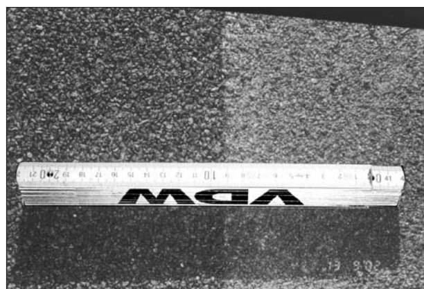
Bild 5.5: Vergleich der Oberflächen mit AbstreuSplitt 1/3 und 2/3 mm
