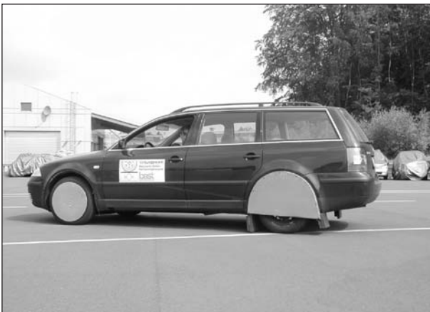
Bild 4.2: Fahrzeugmodifikationen am Radhaus durch die BAST
