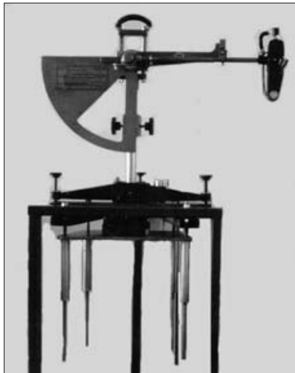
Bild 3: SRT-Pendelgerät auf Einspanntisch
