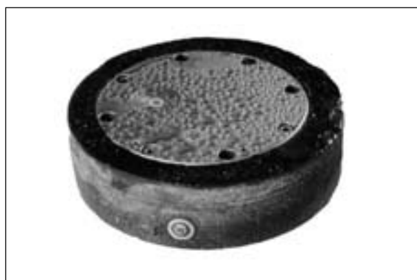
Bild 19: Sensorblock mit einem Wasserfilm von 0,27 mm Dicke
