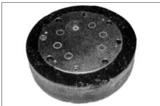
Bild 17: Sensorblock mit einem Wasserfilm von 0,15 mm Dicke
