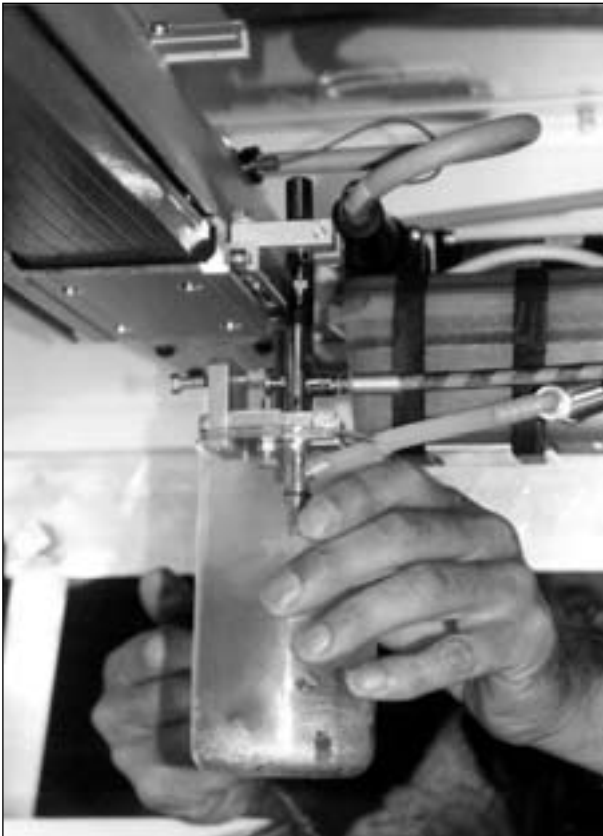
Bild 13: Auffangen der Spritzmenge mit einem Becherglas
