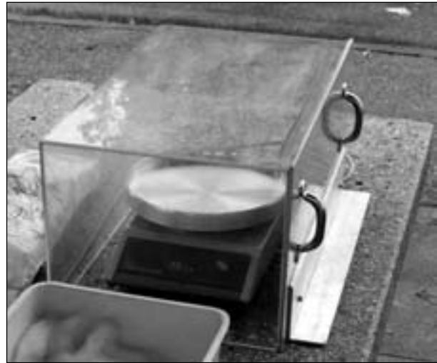
Bild 9: Waage mit Glaskasten als Windschutz, rechts separates Blech zum Öffnen des Kastens
