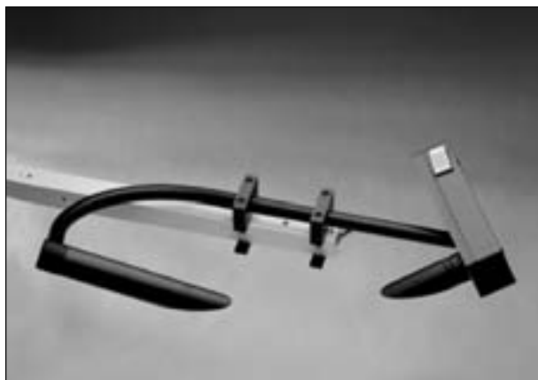
Bild 4: Present Weather Sensor PWD 11 der Firma Vaisala, Kombination eines Sensors nach dem Lichtstreuprinzip mit einem kapazitiven Sensor (helles Plättchen auf dem rechten Kasten)
