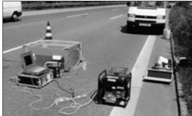
Bild 14: Einsatz der Kalibriervorrichtung auf der Autobahn
