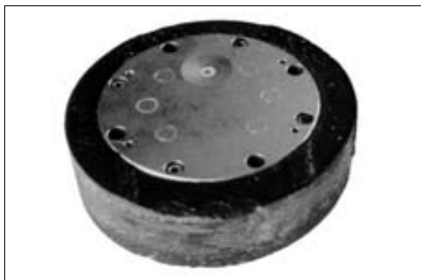
Bild 15: Sensorblock mit einem Wasserfilm von 0,03 mm Dicke
