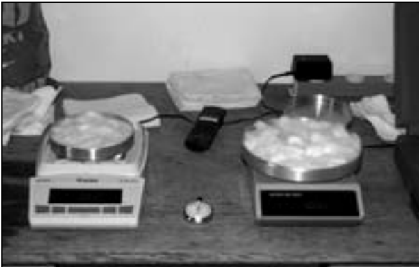
Bild 7: Wägung der Schalen im Labor, zur Vermeidung des Wegspringens von Wassertropfen sind die Schalen mit Watte gefüllt (links Schale mit 200 cm 2 Auffangfläche, rechts Schale mit 400 cm 2 Auffangfläche)
