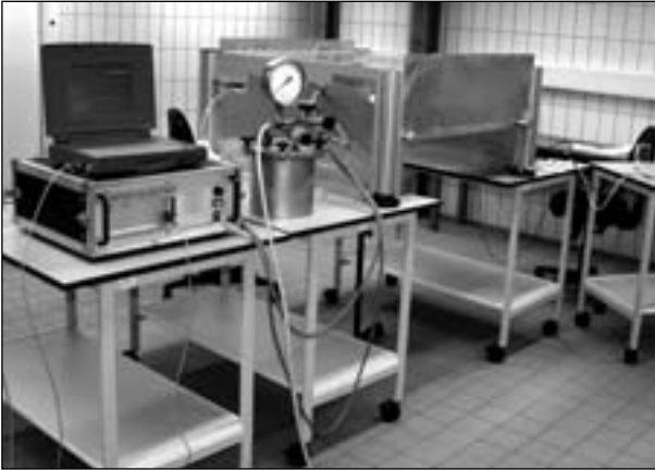
Bild 5: Ansicht der Kalibriervorrichtung im Labor, links Steuervorrichtung für die maschinelle Führung des Sprühventils, in der Mitte Drucktopf für Tausalösungen, rechts Gestell mit beweglicher Baueinheit für die Sprühventilführung
