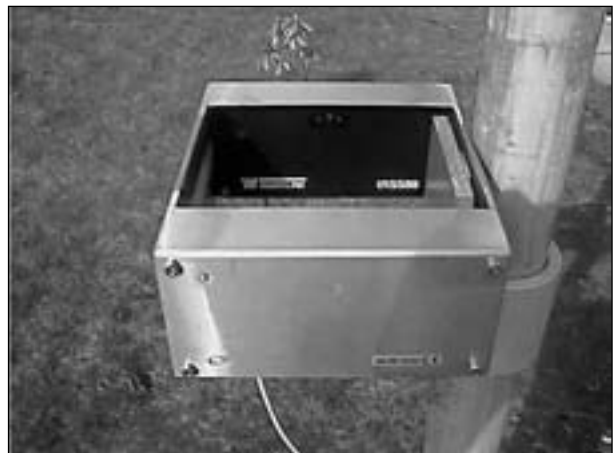
Bild 1: IRSS88-Sensor (Lieferant: Firma MickS) nach dem Lichtschrankenprinzip; die Niederschlagsintensität wird nach Anzahl, Größe und Fallgeschwindigkeit der Niederschlagspartikel bestimmt
