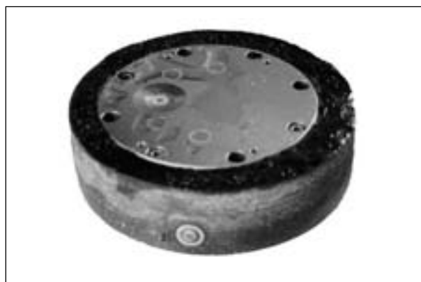
Bild 20: Sensorblock mit einem Wasserfilm von 0,27 mm Dicke, verwischt
