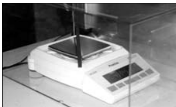
Bild 8: Wägung eines Prüfstreifens in einem Glaskasten auf einer Waage mit 0,001 g Auflösung
