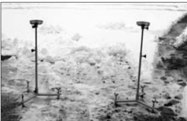
Bild 8: Zwei Auffangschalen mit 200 cm 2 Auffangfläche auf den Stativen
