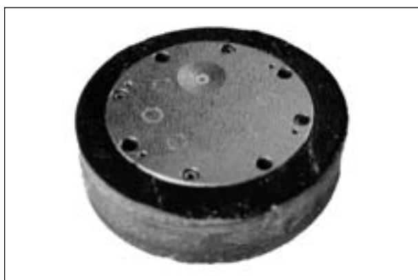
Bild 16: Sensorblock mit einem Wasserfilm von 0,09 mm Dicke
