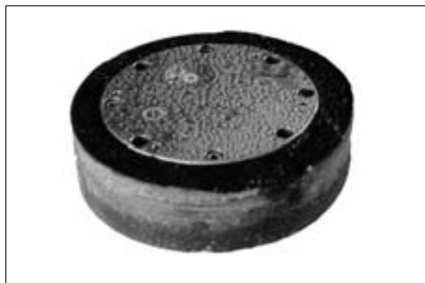
Bild 18: Sensorblock mit einem Wasserfilm von 0,21 mm Dicke
