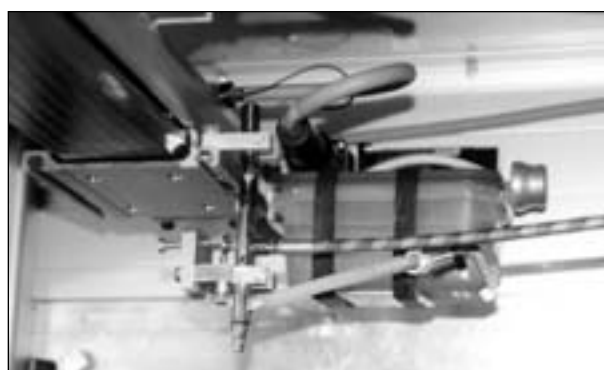
Bild 9: Befestigung der Spritzpistole und des Wasserbehälters an der Verfahrvorrichtung
