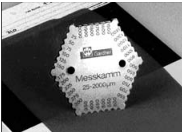
Bild 10: Messkamm für das Messen von Schichtdicken
