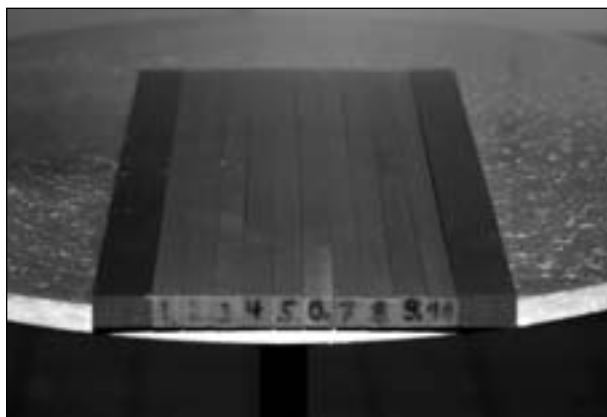
Bild 7: Plastikstäbe für das Aufnehmen von gesprühtem Wasser unter der Sprühvorrichtung für die Messung der Gleichmäßigkeit, die breiteren Außenstäbe dienen der seitlichen Abdeckung der 10 Messstäbe
