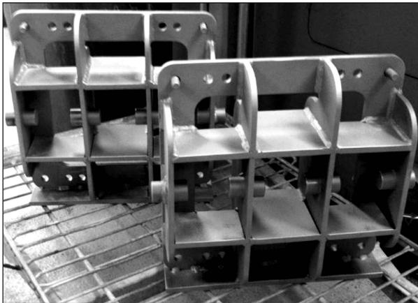
**Bild 52:** Kopfplatten nach dem Pulverstrahlen
