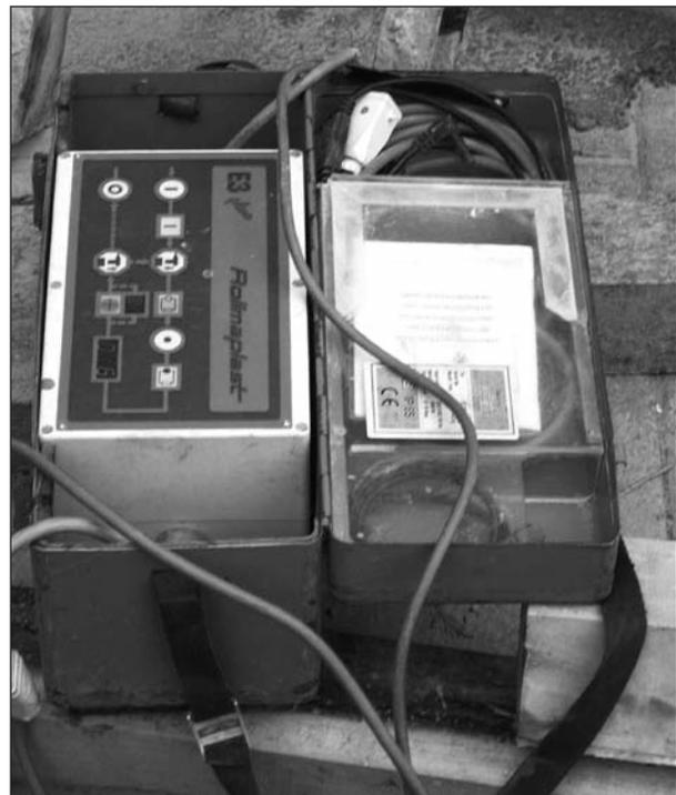
**Bild 41:** Heiz- und Steuergerät für die Herstellung einer Elektroschweißmuffe
