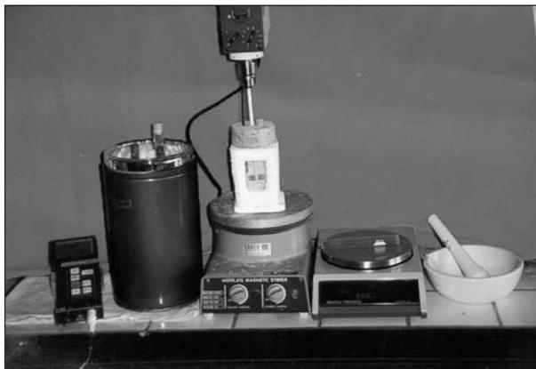
**Bild 31:** Messgeräte zur Bestimmung der spezifischen Wärmekapazität [35, 28]
