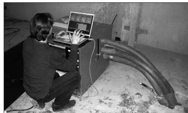
**Bild 25:** Messeinrichtung zur Durchführung eines Thermal-Response-Tests an einer Doppel-U-Sonde
