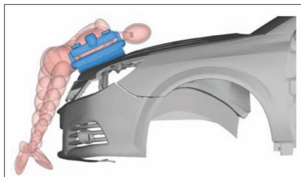
Bild 68: Vergleich des Anpralls eines 6-jährigen Kindes mit einem Hüftimpaktor
