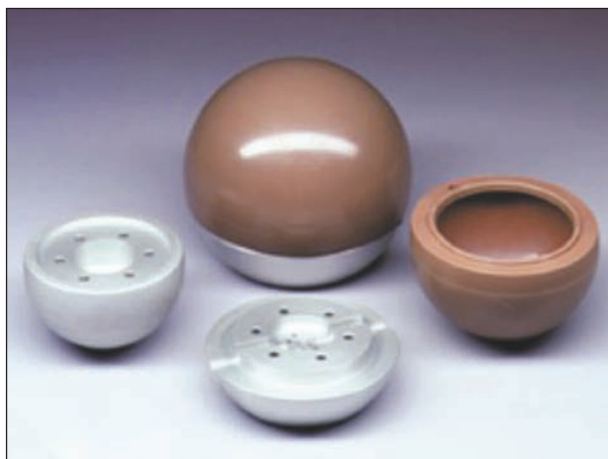
Bild 21: Darstellung und Aufbau eines Kopffimpaktors (Humanetics, 2011)
