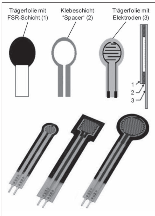
Bild 9: FSR-Sensoren: Prinzipdarstellung (oben), Ausführungsbeispiele (unten) (FSR, 2010)
