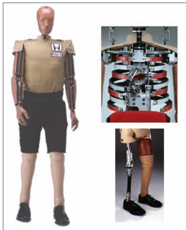
Bild 22: Polar-II-Dummy von Honda (Honda, 2004; TAKAHASHI, 2007)
