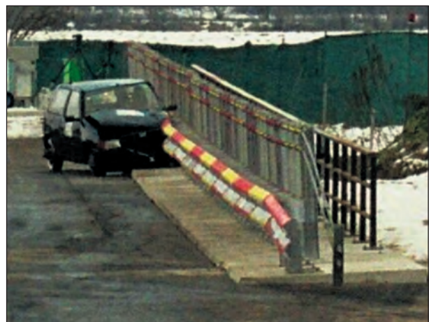
Bild 39: Anprall TB 11 an das System E
