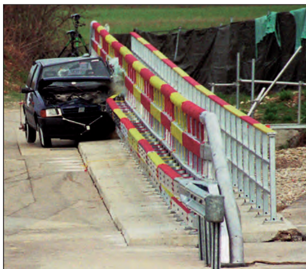
Bild 29: Anprall TB 11 an das System C
