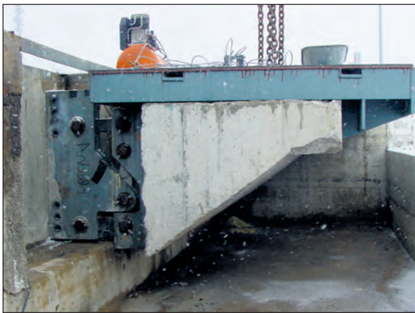
Bild 13: Blick in die Messgrube mit aufgehängter Konsole und Stahlkonstruktion, ohne Stahlbetonkappe (Bild: TÜV Automotive GmbH)
