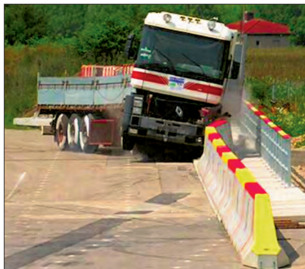
Bild 21: Anprall TB 81 an das System A
