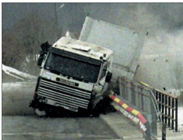
Bild 41: Anprall TB 81 an das System E
