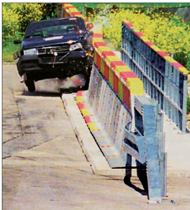
Bild 34: Anprall TB 11 an das System D
