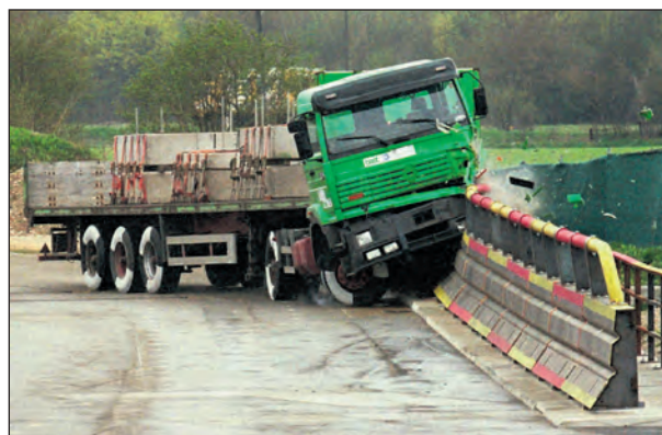
Bild 46: Anprall TB 81 an das System F
