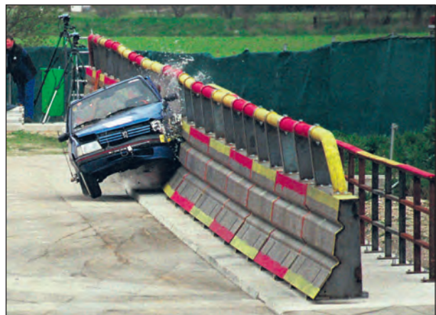
Bild 44: Anprall TB 11 an das System F
