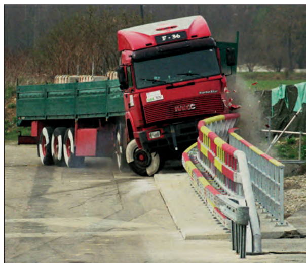
Bild 31: Anprall TB 81 an das System C
