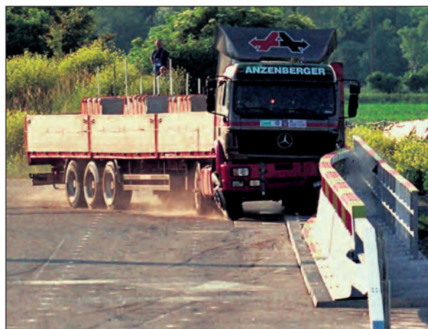
Bild 36: Anprall TB 81 an das System D
