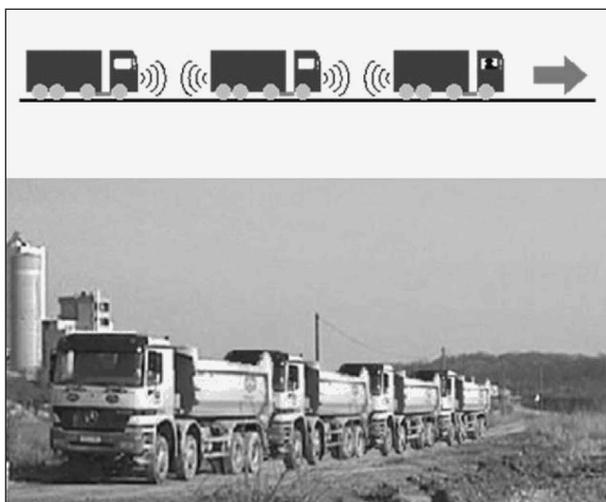
**Bild 39:** Steuerung von Lkw über elektronische Deichsel [GÖTTING KG 2010]
