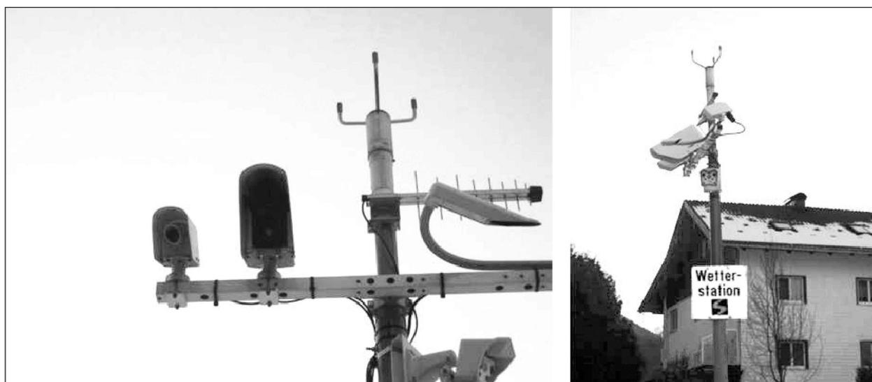
**Bild 20:** Messstation des Landes Salzburg zur berührungslosen Messung des Fahrbahnzustandes mit dem System DSC 111 [VAISALA]
