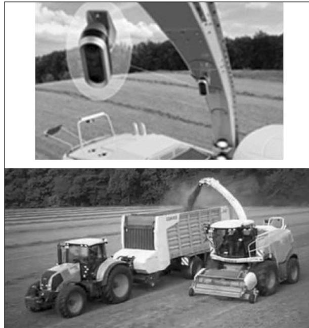
**Bild 35:** Auto-Fill-Kamera am Auswurf des Erntefahrzeugs; Auto Fill im Einsatz mit Ernte- und Transportfahrzeug [CLAAS 2010]
