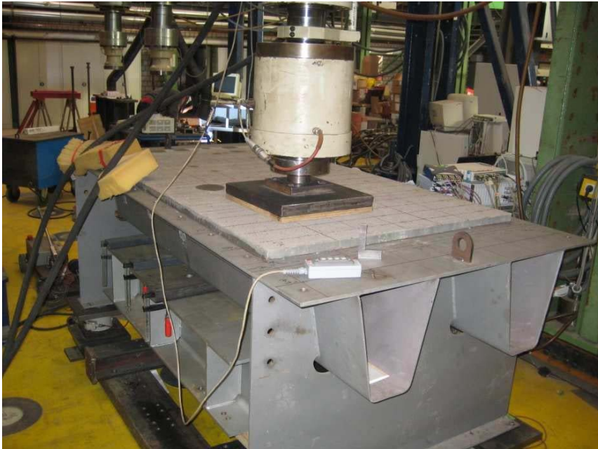
Bild 10: Versuchsaufbau – Fertigteile aus UHPC – Untersuchungen an der TU Dortmund [9]
