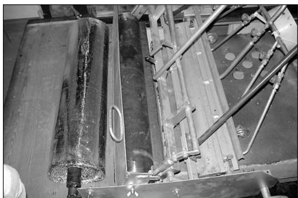
Bild 24: Aufschweiß-Verlegegerät; links: Bitumenschweißbahn mit Aluminiumkaschierung, rechts davon: Stahlzylinder anstelle der Schweißbahnrolle
