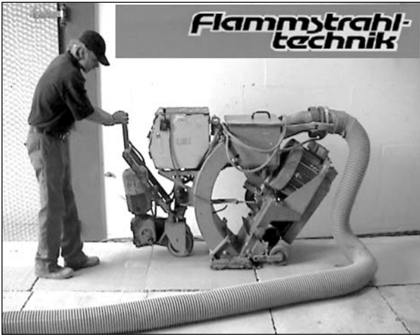
Bild 1: Kugelstrahlmaschine 1-15 DS der Fa. Blastrac, Arbeitsbreite: 380 mm
