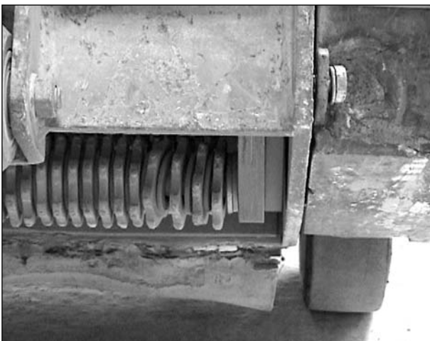
Bild 3: Detail Klopffräse; Teilansicht einer Welle mit Schlaglamellen und Distanzscheibe
