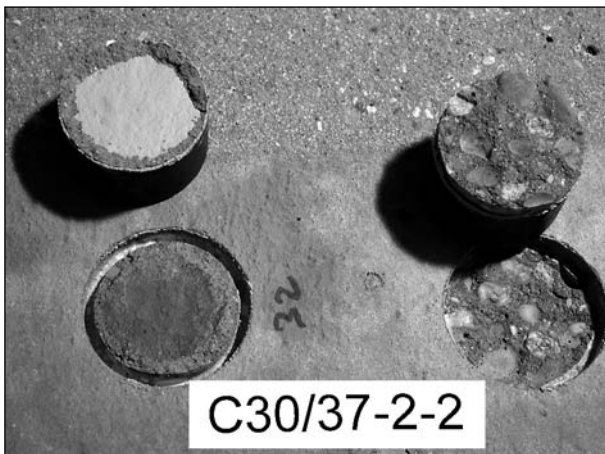
Bild 41: links: Adhsionsbruch aufgrund fehlender Oberflchenvorbereitung; ohne Grundierung
