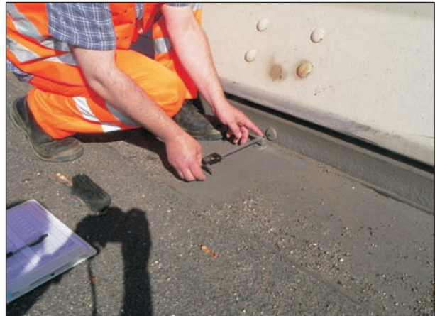
Bild 8: Messung der jahreszyklischen Fugenbewegungen
