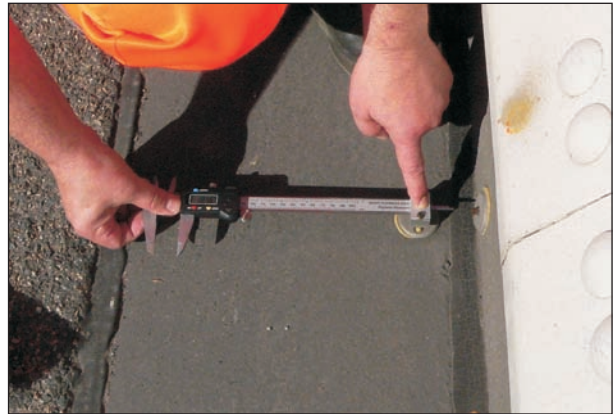
Bild 9: Messung der jahreszyklischen Fugenbewegungen
