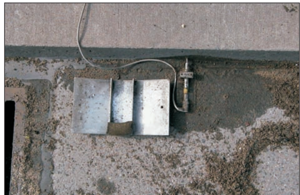
Bild 4: Messeinrichtung zur Messung der hochfrequenten Fugenbewegungen
