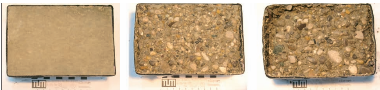
Bild 27: Oberfläche eines Probekörpers des Betons RV03 („CEM II A-LL 32,5 R/0,60“) vor (links) sowie nach 14 (Mitte) und 28 (rechts) Frost-Tau-Wechseln geprüft am Institut des Auftraggebers
