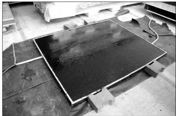
Bild 39: Fertig asphaltierter Probekörper mit Trägermatte
