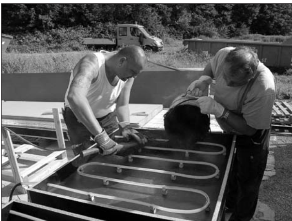
Bild 43: Asphaltieren eines Probekörpers
