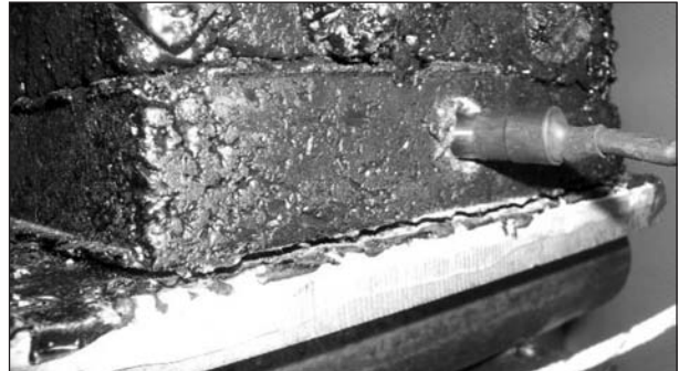
Bild 65: Prüfkörper-Riss im Bereich der Pufferschicht
