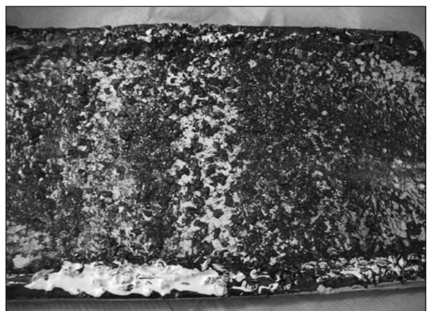
Bild 67: Aufgetrennter Probekörper im Bereich der Pufferschicht
