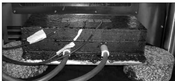
Bild 31: Untersuchungen in der Klimakammer zur Rohrpositionierung – Versuchsaufbau (Lage der Rohre auf Dichtungsschicht mit 15 cm Rohrabstand, KT A_15)
