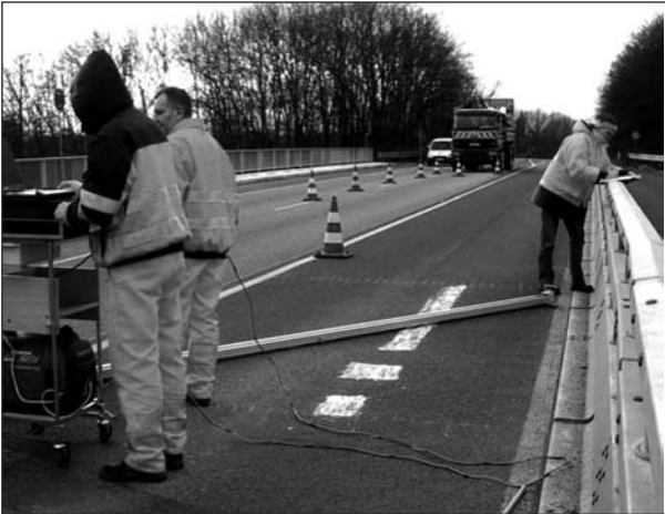
Bild 117: Messungen der Oberflächen Textur im Bereich der Eingebauten Rohre durch die BAST
