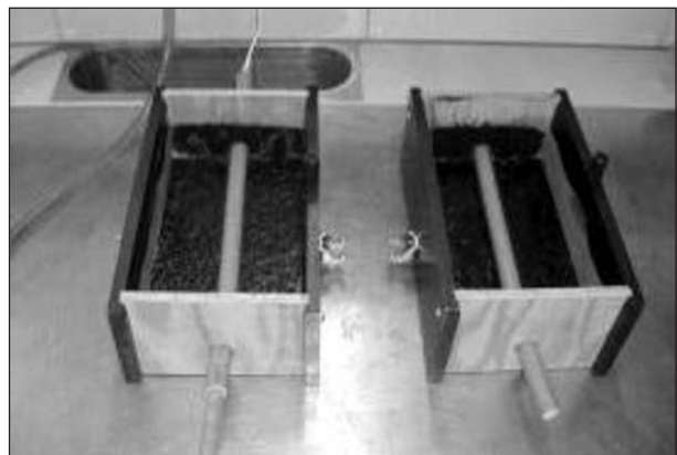
Bild 21: Asphalteinbau – Rohre PE-RT (mit und ohne Wasserkühlung)
