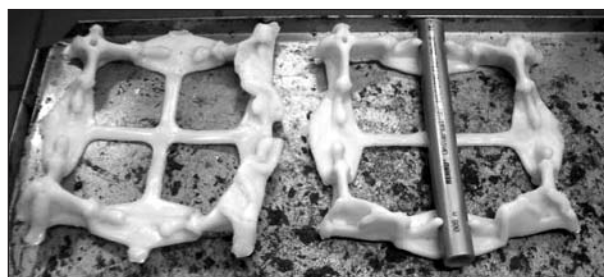
Bild 37: Befestigungsgitter nach der thermischen Beanspruchung im Laborofen bei 250 °C
