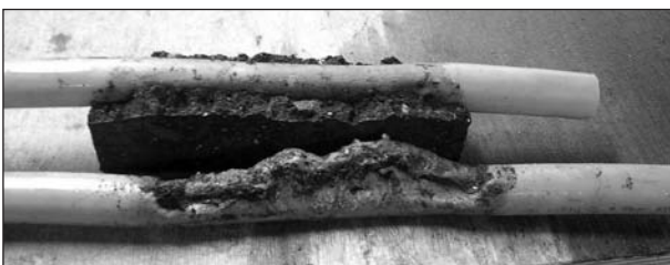
Bild 20: Verformtes Rohr (Vordergrund) (PE-RT) nach Einbau im Gussasphalt (2. Lieferung)
