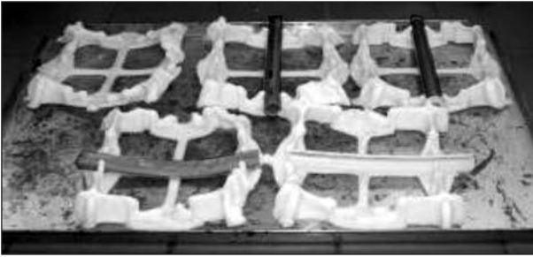
Bild 27: Rohre und Befestigungsgitter nach der thermischen Beanspruchung im Laborofen bei 250 °C
