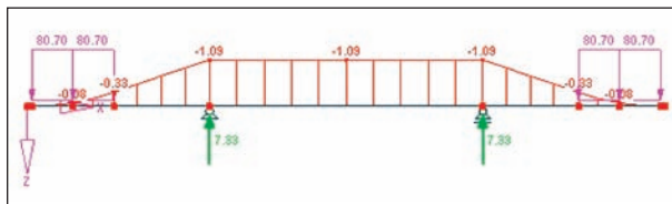
Bild 69: Kräfte sowie resultierende Feld- und Stützmomente (4-Punkt-Biegeversuche)
