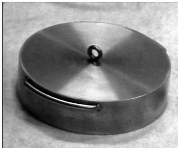
**Bild 4.3:** Edelstahlplatte des Kühlkopfes
