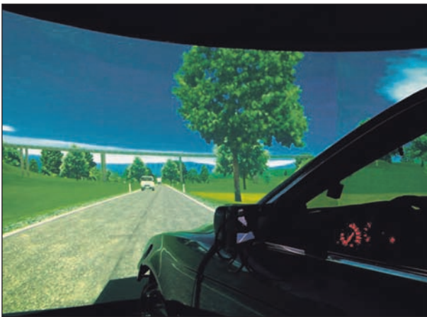
Bild 12: Innenraum des Fahr Simulators mit Bewegungssystem der WIVW GmbH
