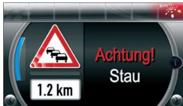
Bild 15: Screenshot der verwendeten präzisen Warnmeldung vor bevorstehendem Stauende (mit Entfernungsangabe)
