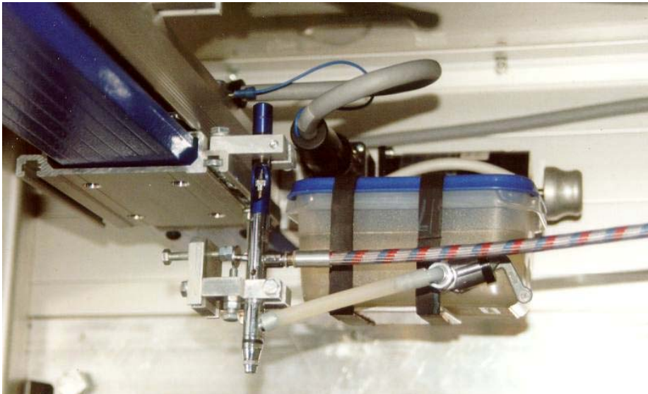
Abbildung 9: Befestigung der Spritzpistole und des Wasserbehälters an der Verfahrvorrichtung
