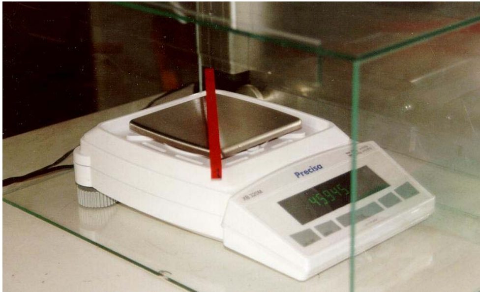
Abbildung 11: Wägung eines Prüfstreifens in einem Glaskasten auf einer Waage mit 0,001 g Auflösung
