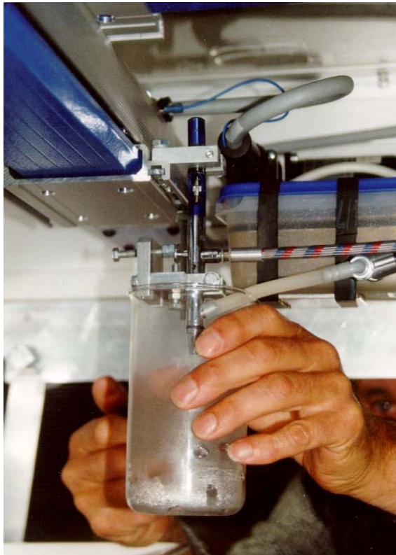
Abbildung 13: Auffangen der Spritzmenge mit einem Becherglas
