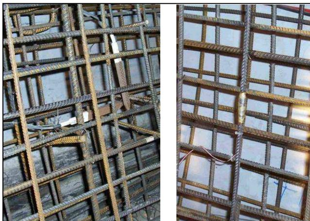
Bild 21: a. DMS im Beton b. DMS an Bewehrungsstäben
