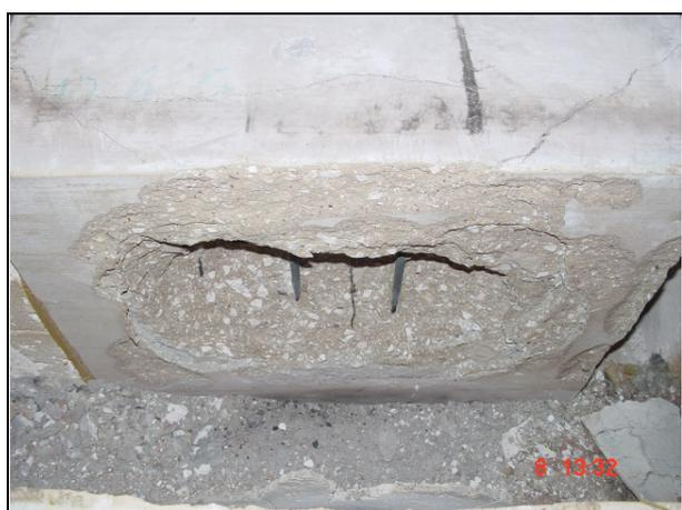
**Bild 13:** In Wasser konditionierte Platte aus SVB-Schloßberg tunnel
