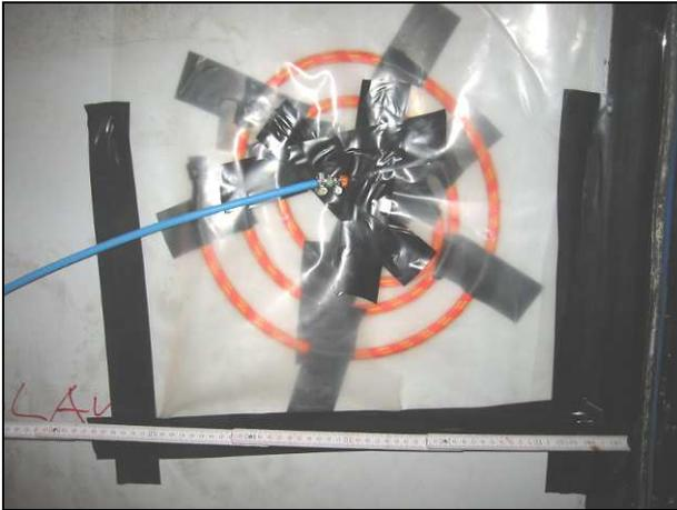
Bild 88: Einbautes Injektionsmodul
