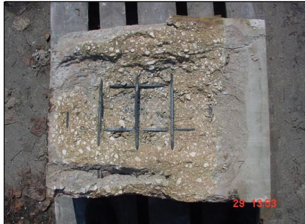
Bild 17: Oberfläche des SVB für den Schloßbergtunnel
