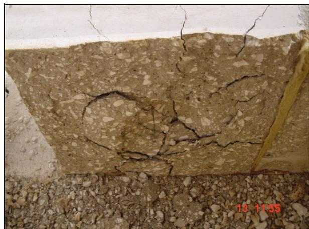
Bild 8: Beflammte Oberfläche d. wassergelagerten V18
