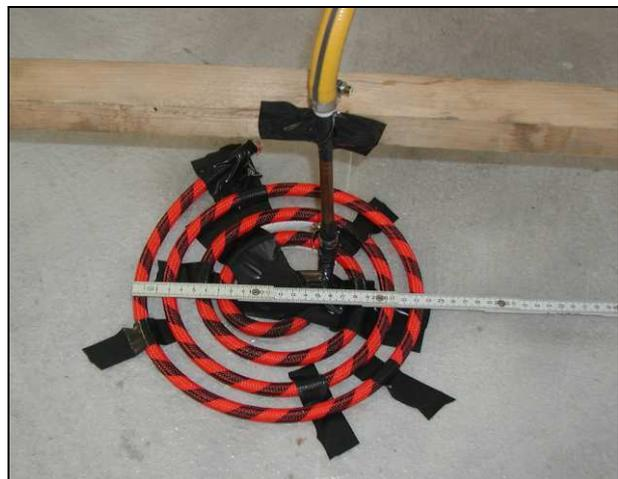
Bild 83: Injektionsschlauch auf dem Probekörper nach dem 1. Betonierabschnitt
