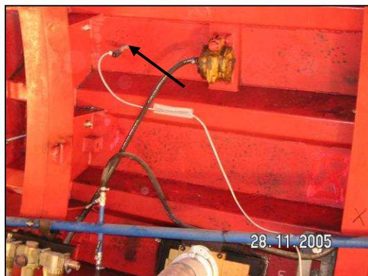
Bild 27: Drucksensor
