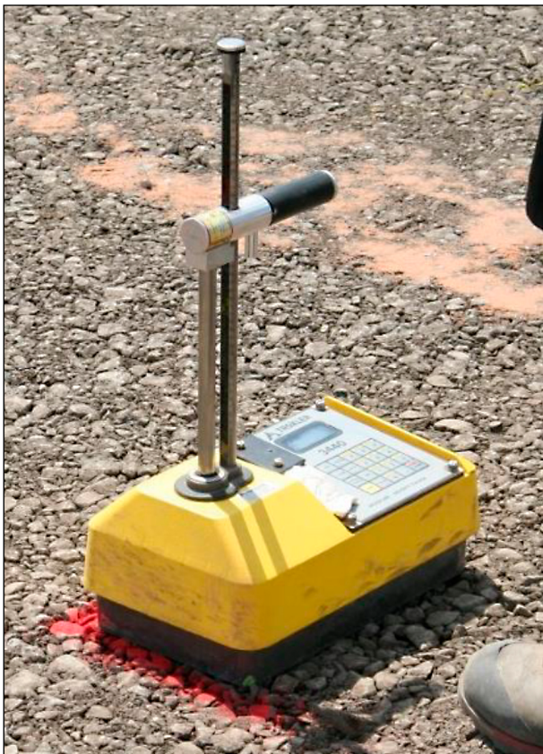
Bild 9: Radiometrische Sonde zur Dichte- und Wassergehaltsbestimmung, Typ Troxler 3440
