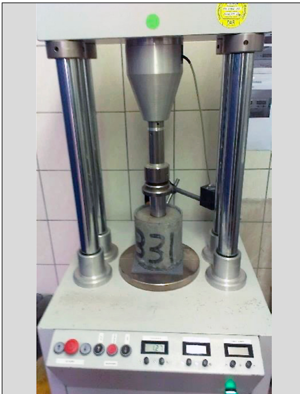
Bild 104: CBR-Apparatur nach TP BF-StB am FEhS-Institut
