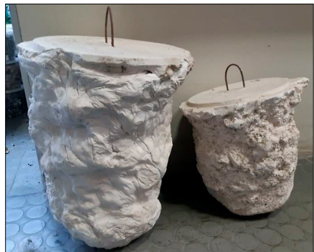
Bild 44: Gipskörper zur Volumenermittlung mit dem Gipsersatzverfahren nach DIN 18125-2 mit (links) und ohne (rechts) Verwendung von in Öl getränkten Zellstoffstreifen
