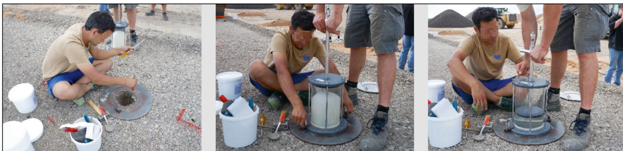
Bild 7: Dichtebestimmung mit dem Ballon-Verfahren nach DIN 18125-2 (DIN, 2020)
