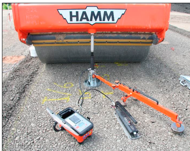
Bild 15: Statischer Plattendruckversuch nach DIN 18134 (DIN, 2012a)
