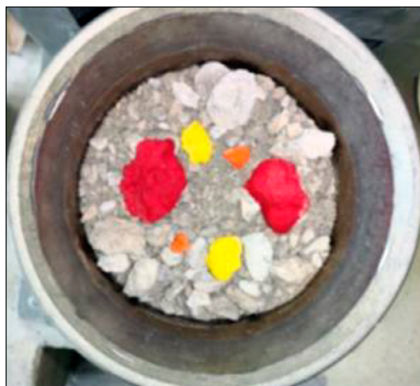
Bild 102: Platzierung der farblich eingefärbten Einzelkörner auf der mittleren Schicht bei der Verdichtung im Proctor
