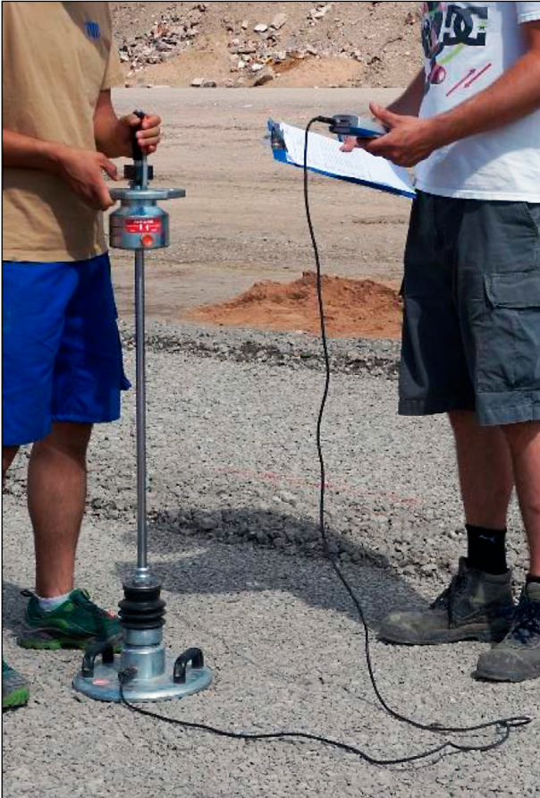
Bild 19: Durchführung eines dynamischen Plattendruckversuches nach TP BF-StB B 8.3 (FGSV, 2012b)
