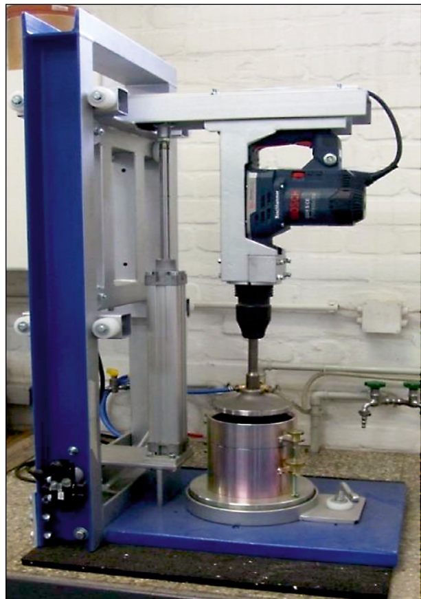
Bild 4: Vibrationshammer nach DIN EN ISO 1386-4, aus BIALUCHA et al. (2016)
