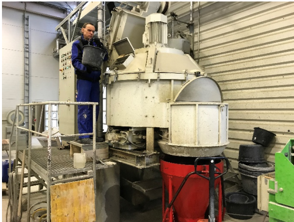
Abbildung 6.9: Mischen der einzelnen Betonchargen mittels Zwangsmischer
