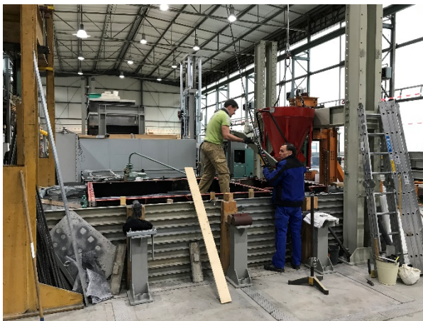
Abbildung 6.11: Positionierung des Betonsilos über dem großmaßstäblichen Versuchstand mittels Kranbahn
