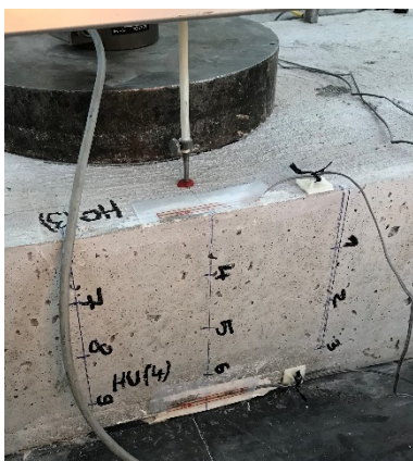
Abbildung 6.21: Messpositionen für die Ultraschalllaufzeitmessungen sowie mittlerer IWA und DMS an der hinteren Flanke des Probekörpers
