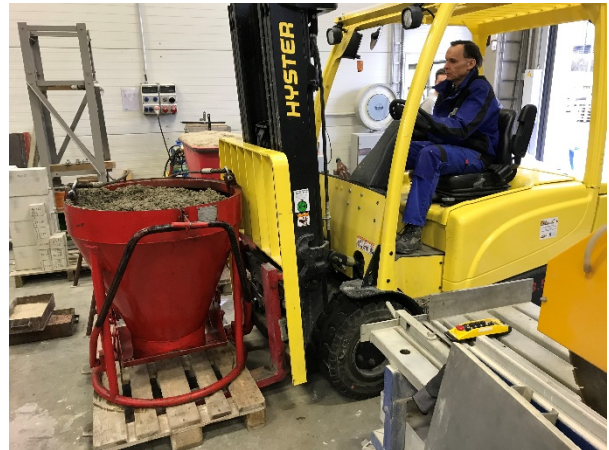
Abbildung 6.10: Transport des Frischbetons vom Zwangsmischer zum großmaßstäblichen Versuchstand mittels Betonsilo
