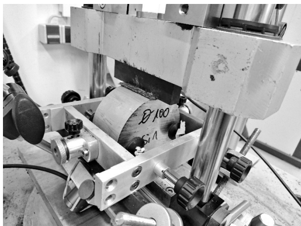
Abbildung 3.26: Im Spaltzug-Schwellversuch eingebauter Aluminium-Probekörper
