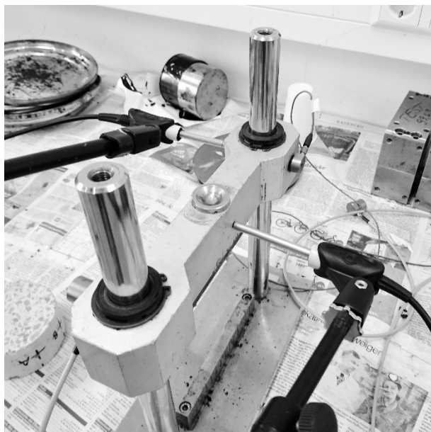
Abbildung 3.22: Messaufbau zur Bestimmung der Eigenfrequenzen des SZSV-Prüfstands
