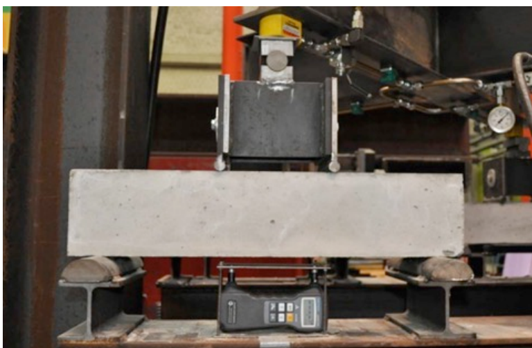
Abbildung 2.30: Ultraschalllaufzeitmessung der Rayleigh-Welle eines Vierpunkt-Biegebalkens unter zyklischer Beanspruchung [Breitenbücher / Kunz – 2017]
