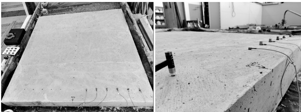
Abbildung 6.45: Versuchsaufbau zur Durchführung der Phase-Shift-Methode an der Betonplatte
