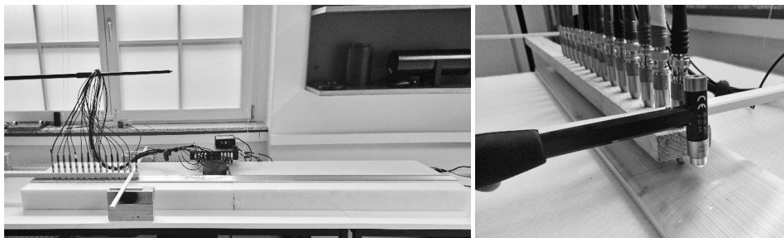
Abbildung 5.2: Messaufbau an Aluminium-Streifen 1; links: gesamter Messaufbau; rechts: Mikrofon-Array und Impulshammer
