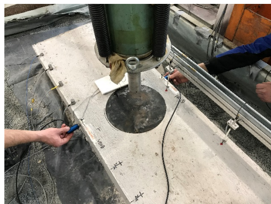
Abbildung 6.22: Messen der Ultraschalllaufzeiten am Betonplattenstreifen während einer Belastungspause
