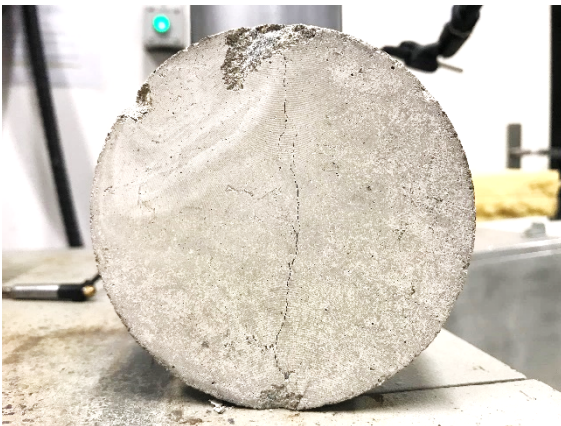
Abbildung 3.17: Probekörper nach Ermüdung und Schädigung mittels des optimierten Versuchsprogrammes des Spaltzug-Schwellversuches in der zweiten Generation nach Versuchsende; deutliche Ausbildung eines Makrozugrisses entlang der Belastungsebene auf der Probekörperoberfläche; der Probekörper wurde bis zu einem Grenz-E-Modul entsprechend 10 % des ursprünglichen E-Moduls ermüdet
