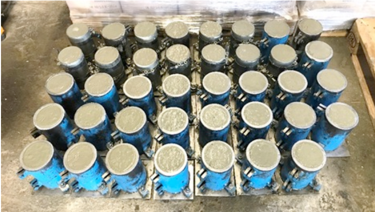
Abbildung 3.1: Straßenbetonprobekörper für die Voruntersuchungen, zylindrische Form mit einer Höhe von 200 mm und einem Durchmesser von 100 mm
