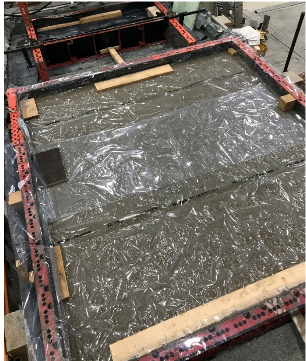
Abbildung 6.16: Abschließendes Abdecken der betonierten Probekörper zur Gewährleistung optimaler Hydratationsbedingungen
