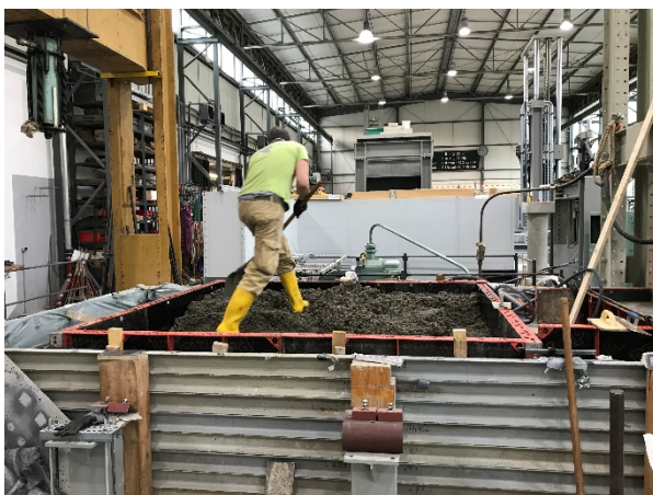
Abbildung 6.13: Einfüllen vier weiterer Chargen Frischbeton in das geschalte Profil der Betonplatte
