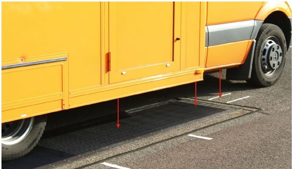
Prüfung der Lasersensorik auf dem duraBASt.
