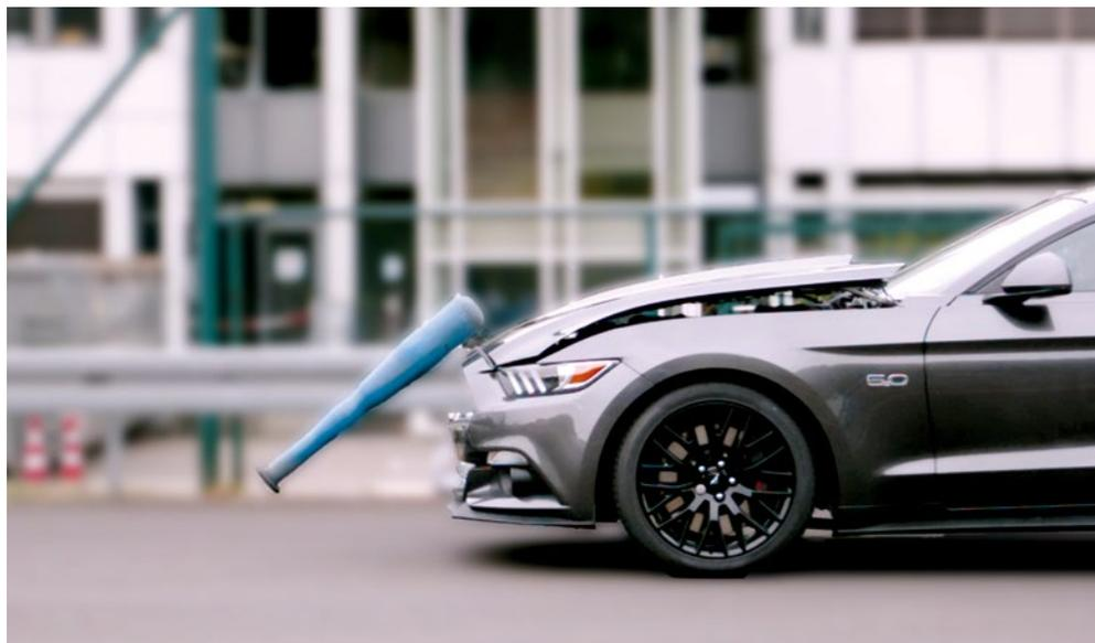
Prüfung der Sensorik eines aktiven Systems mittels Anpralltest gegen ein Fußgänger-Surrogat.
