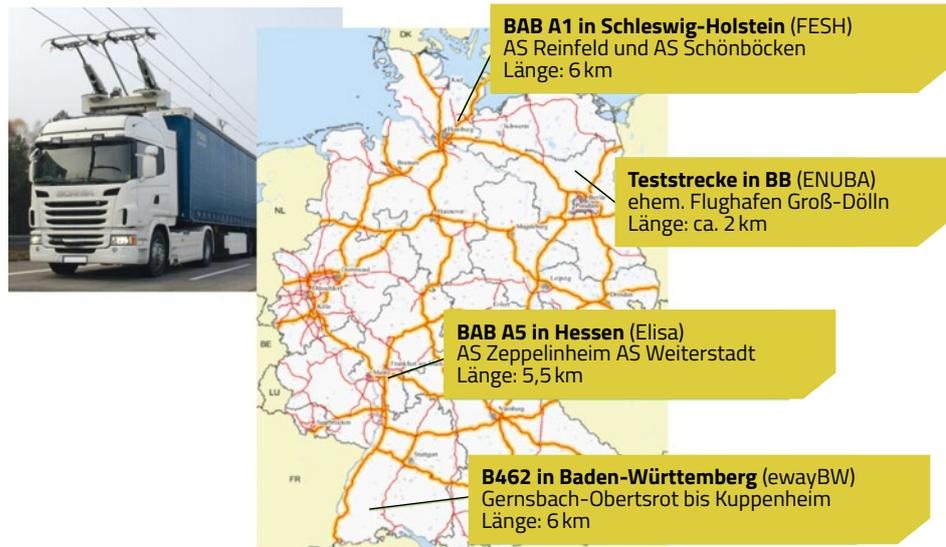
Versuchsstrecken für Oberleitungsbetrieb von Lkw.
