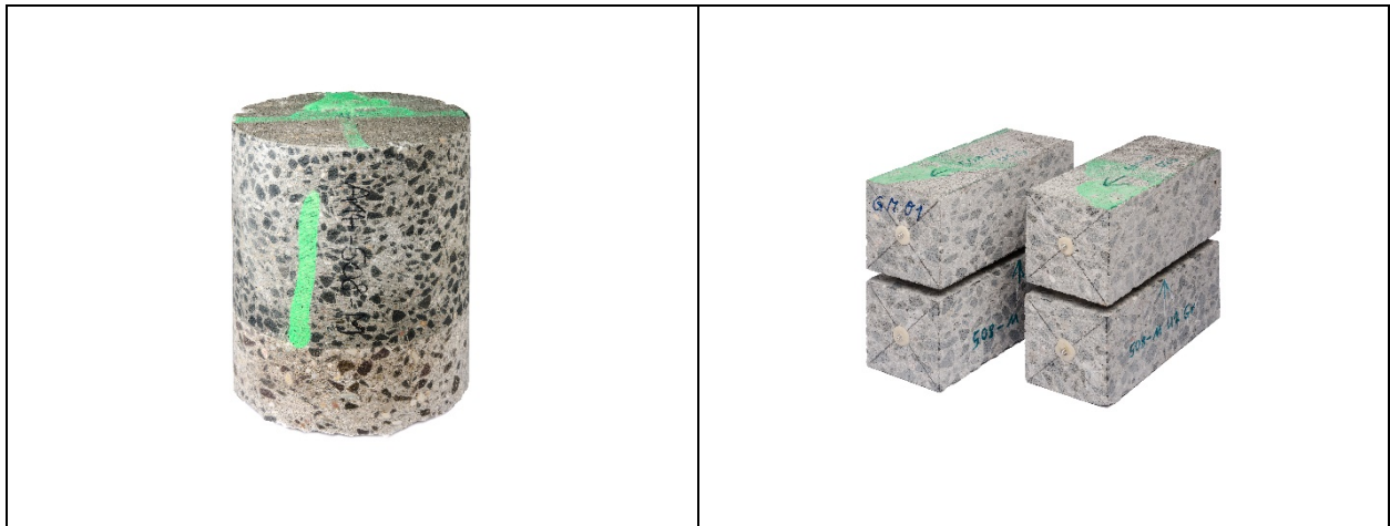
Bild 5-31: Gewinnung von prismatischen Prüfkörpern (rechts) aus Bohrkernen mit einem Durchmesser von 360 mm (links)
