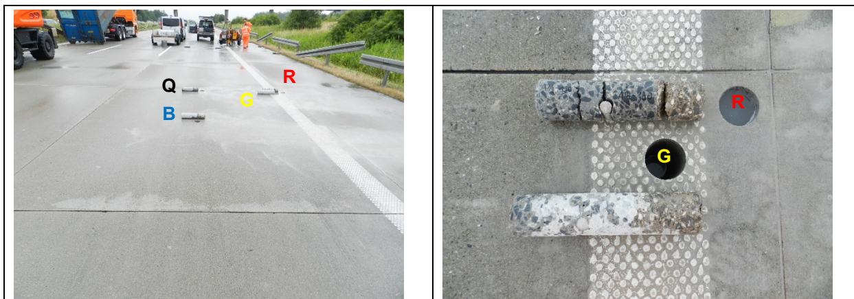
Bild 5-18: Übersichtsaufnahme der Bohrkernentnahme bei Platte Nr. 190 (links) und zugehörige Detailaufnahme der Bohrkernentnahme im Bereich des Fugenkreuzes (rechts). Der Abstand der Bohrlochmitten zur Fuge beträgt 8 cm bzw. 26 cm (rechts)
