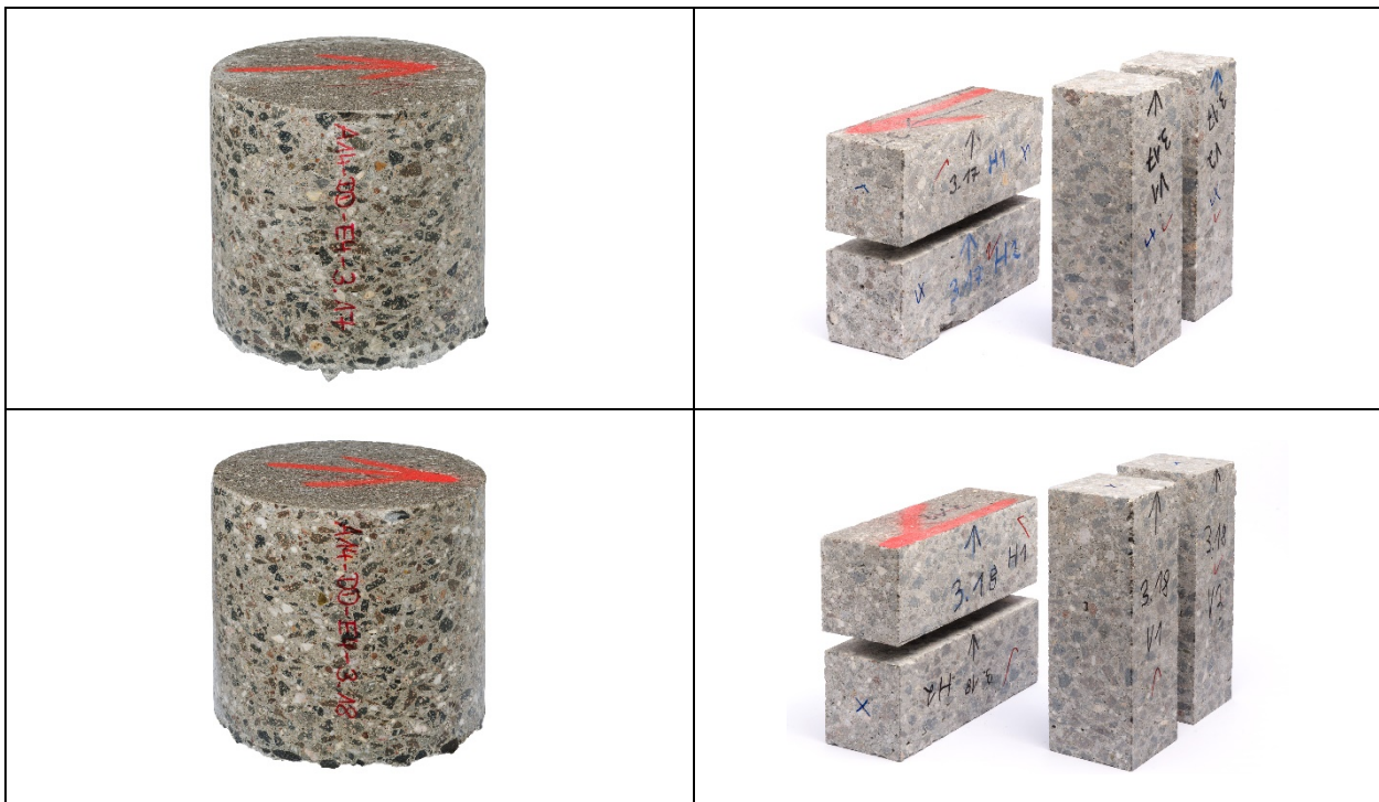
Bild 5-29: Gewinnung von prismatischen Prüfkörpern (rechts) aus Bohrkernen mit einem Durchmesser von 360 mm (links)
