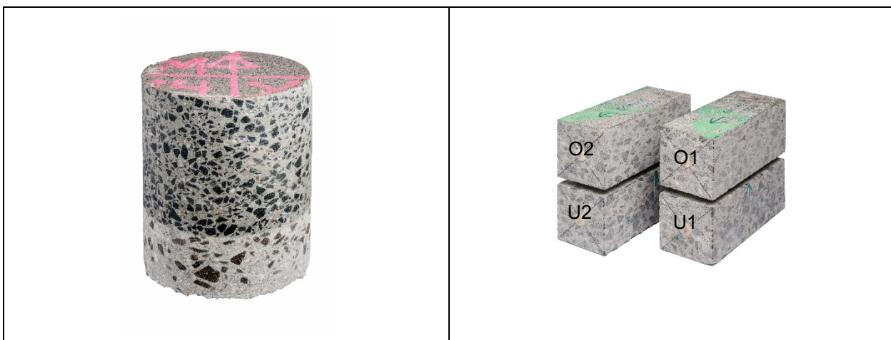
Bild 5-35: Beispiel der Entnahme prismatischer Prüfkörper (rechts) aus einem Bohrkern mit Durchmesser 360 mm (links)
