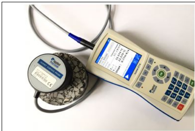
Bild 4-3: Wärmeleitfähigkeitsmessgerät ISOMET 2114 der Firma Applied Precision Ltd. (CLAUß 2019)
