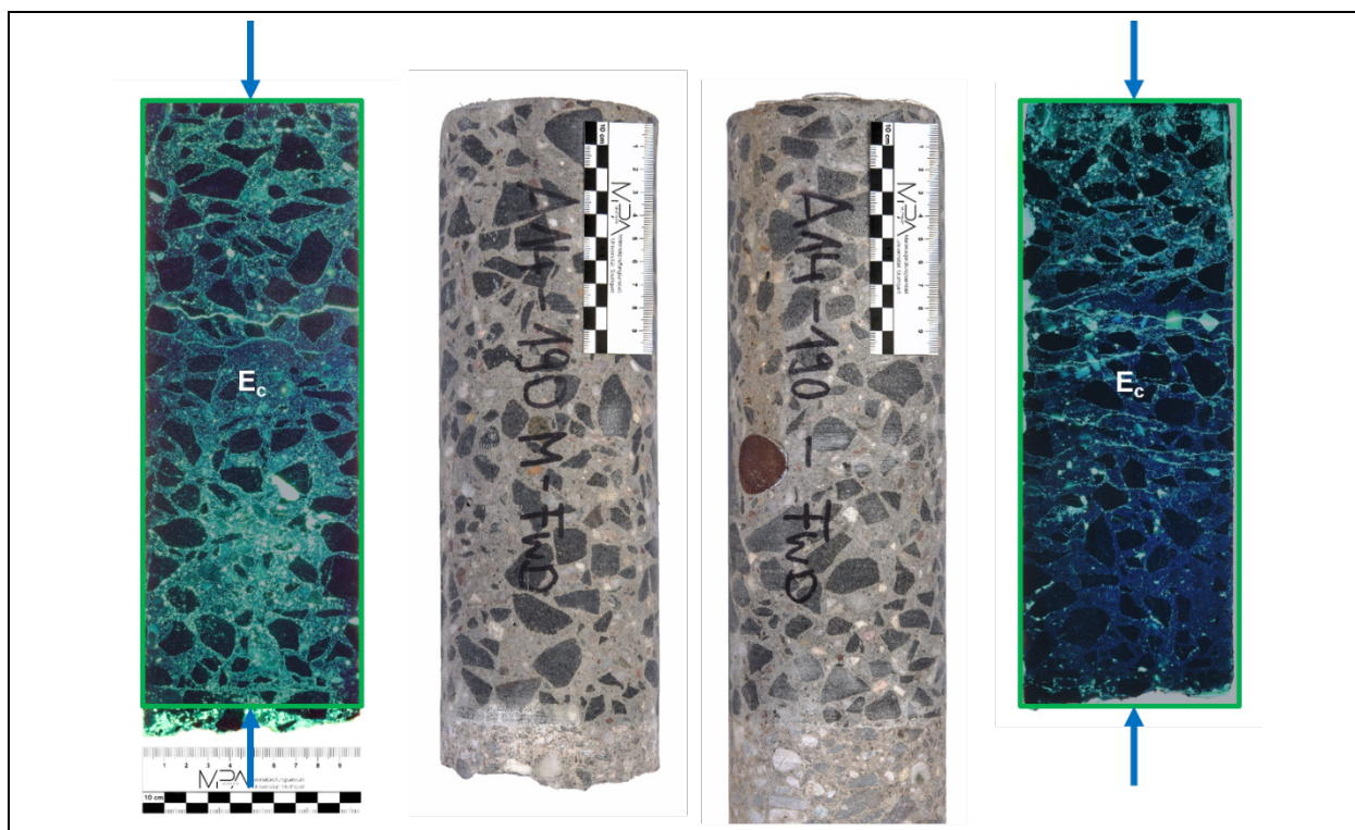
Bild 5-26: Einfluss der Prüfrichtung im Druckversuch (blaue Pfeile) zur Bestimmung des statischen Elastizitätsmoduls ( E_c ) in Abhängigkeit von Rissbildungen mit horizontaler Ausrichtung an einem Bohrkern aus Plattenmitte (1. Bild von links) sowie im Abstand von 26 cm (G) von Bohrlochmitte zur Quer- und Längsfuge (4. Bild von links)
