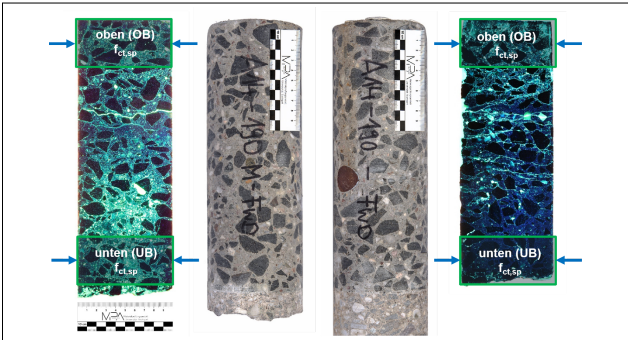
Bild 5-24: Einfluss der Prüfrichtung im Spaltzugversuch (blaue Pfeile) zur Bestimmung der Spaltzugfestigkeit ( f_{ct,sp} ) in Abhängigkeit von Rissbildungen mit horizontaler Ausrichtung an einem Bohrkern aus Plattenmitte (1. Bild von links) sowie im Abstand von 26 cm (G) von Bohrlochmitte zur Quer- und Längsfuge (4. Bild von links)
