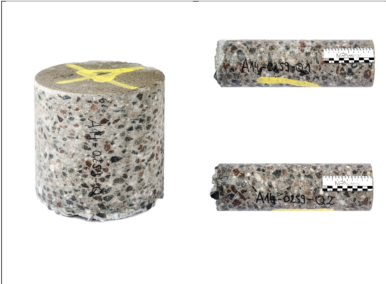
Bild A - 15: Bohrkerne aus 2.ÜFS, Entnahmestelle „Querfuge“, Platten-Nr. 0259
