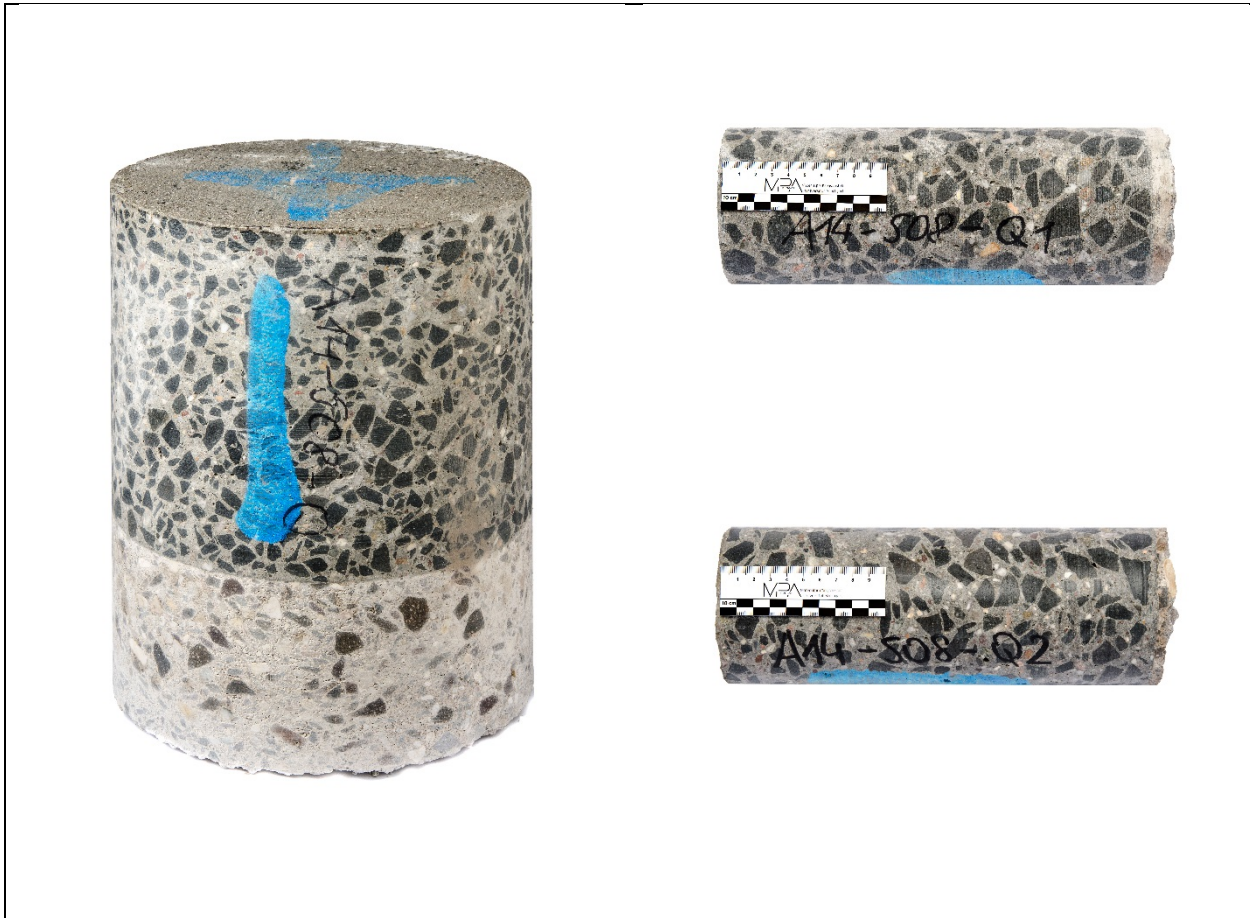
Bild A - 29: Bohrkernentnahmestelle 2.ÜFS „Querfuge“, Platten-Nr. 0508
