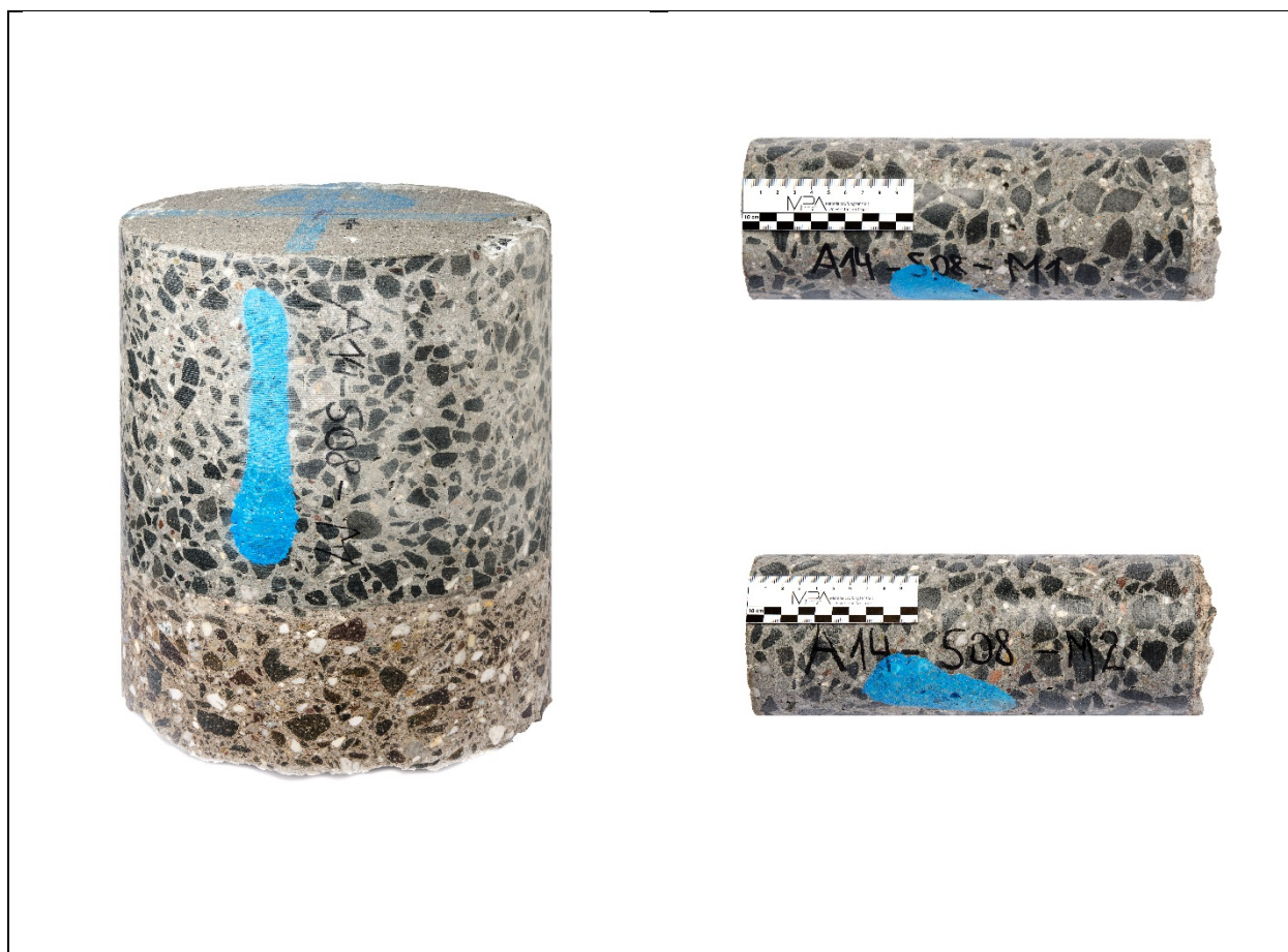
Bild A - 30: Bohrkerne Entnahmestelle 2.ÜFS „Plattenmitte“, Platten-Nr. 0508
