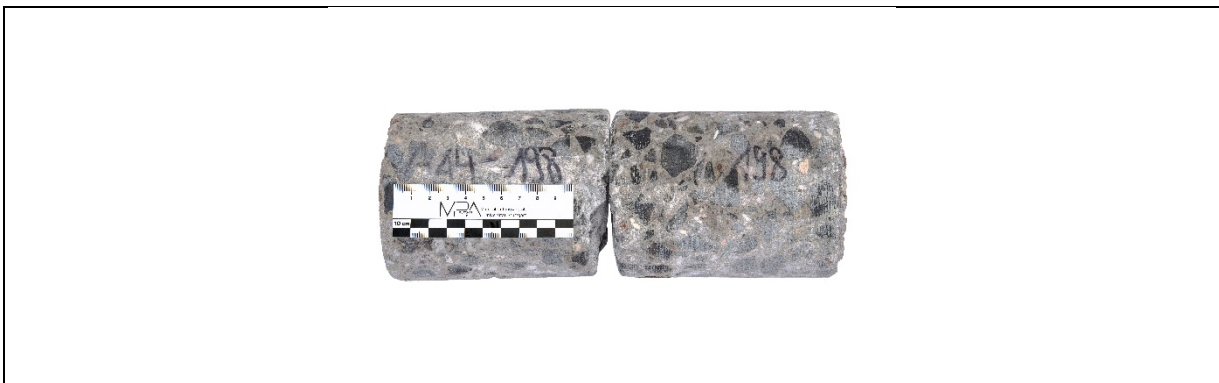
Bild A - 46: Bohrkerne (R) aus Platten-Nr. 198
