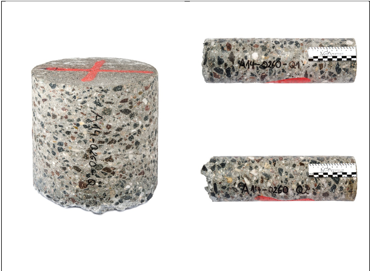
Bild A - 12: Bohrkerne aus HF, Entnahmestelle „Querfuge“, Platten-Nr. 0260
