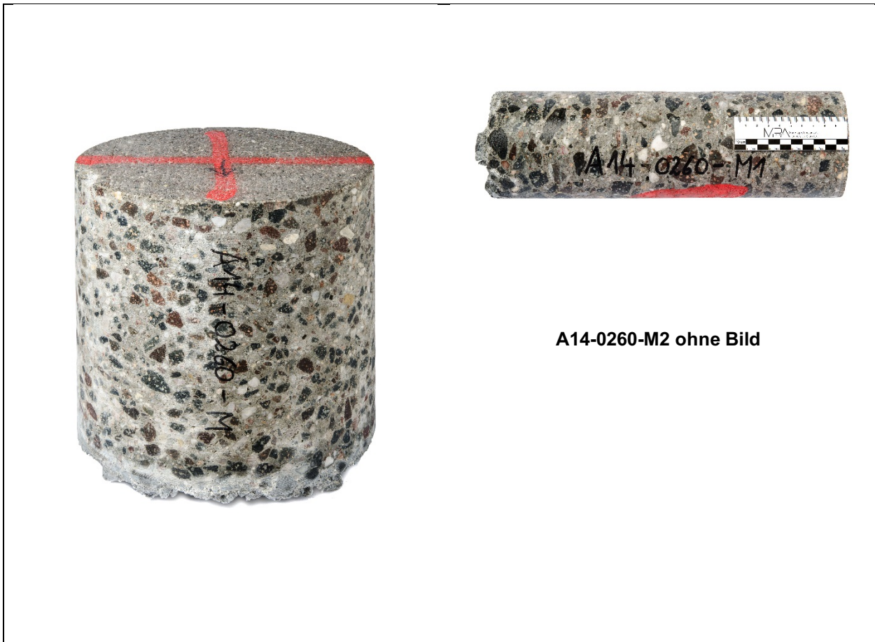
Bild A - 13: Bohrkern aus HF, Entnahmestelle „Plattenmitte“, Platten-Nr. 0260
