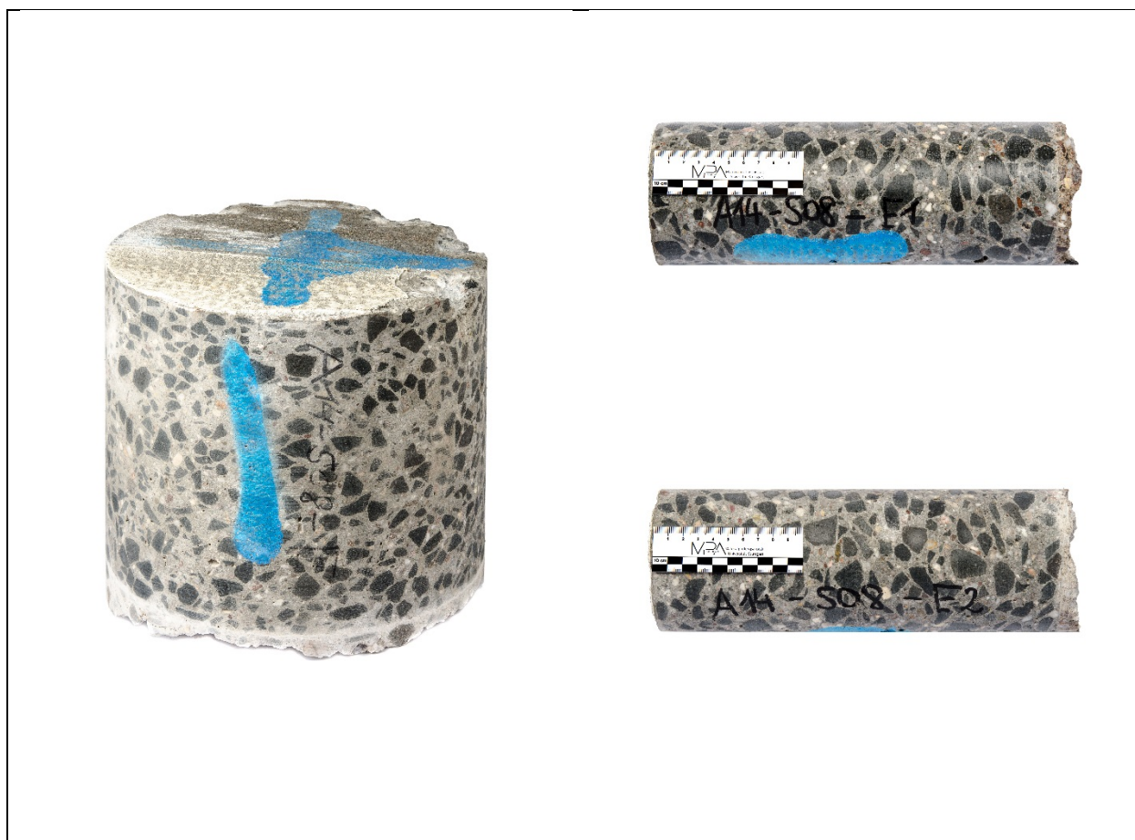
Bild A - 28: Bohrkerne Entnahmestelle 2.ÜFS „Ecke“, Platten-Nr. 0508
