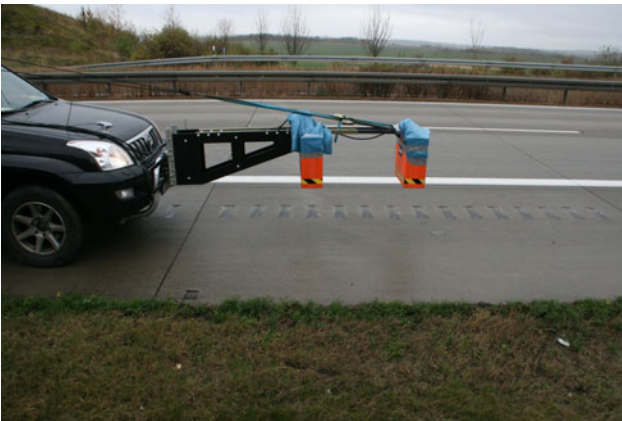
Bild 5.22: SIR-20, 1.000 MHz- und 2.000 MHz Antennen
