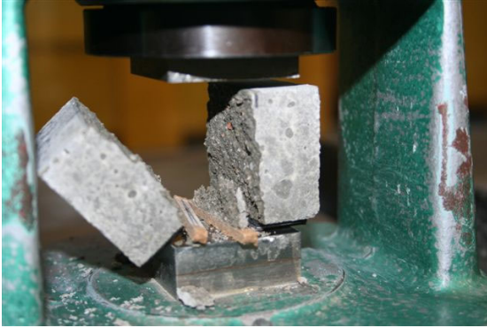
Bild 3.8: Prüfung der Spaltzugfestigkeit
