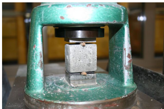
Bild 3.7: Prüfung der Spaltzugfestigkeit
