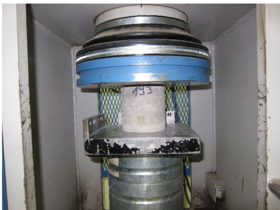
Bild 3.19: Druckprüfung ADR 3000 ELE
