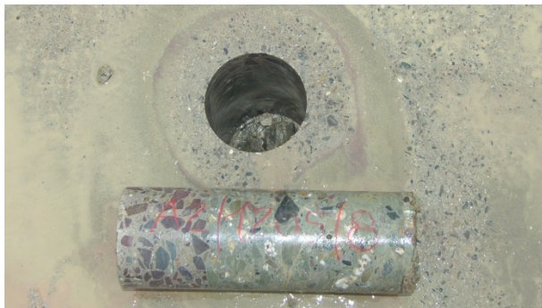
Bild 5.10: Bohrkern mit Beschriftung
