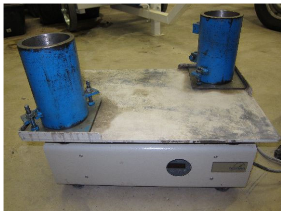
Bild 3.15: Hochfrequenzrütteltisch 250 W/9000 U/min
