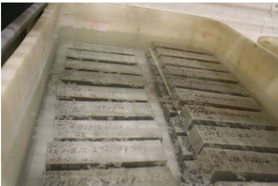
Bild 3.3: Wasserlagerung der Prismen auf Dreikantleisten in Plastikschalen im Klimaraum 20/65
