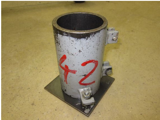
Bild 3.16: Stahlform 7,0 kg bis 7,5 kg
