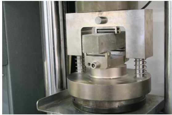
Bild 3.4: Prüfung der Biegezugfestigkeit (Einzellast in Prismenmitte)
