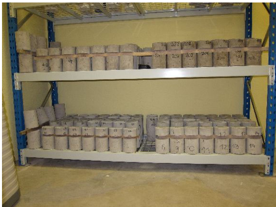
Bild 3.18: Trockenlagerung DIN EN 12390-2 NA
