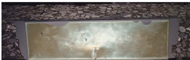
Bild 259: Beispiel des um die Kerbe präparierten Biegebalkens für die Reflexionspolariskopie (Variante XII).
