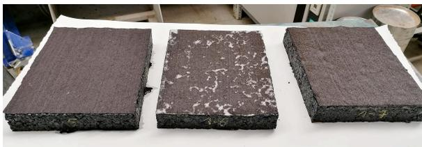
Bild 281: Beispiel für Varianten mit veränderter Emulsionssorte (Variante 1-5, links), verringerter Emulsionsmenge (Variante 1-6, mittig) und doppelter Lage (Variante 1-7, rechts).
