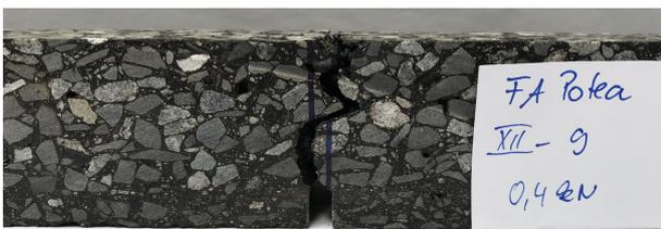
Bild 104: Variante XII (Referenz) nach Versuchsende, Lastamplitude: 0,4 kN, Lastzyklen: ~20.000, durchgängiger Riss.
