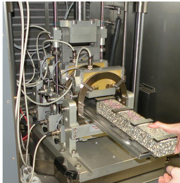
Bild 112: Einbau eines präparierten Probekörpers in den montierten Prüfraumen zur 4-Punkt-Biege-Prüfung.
