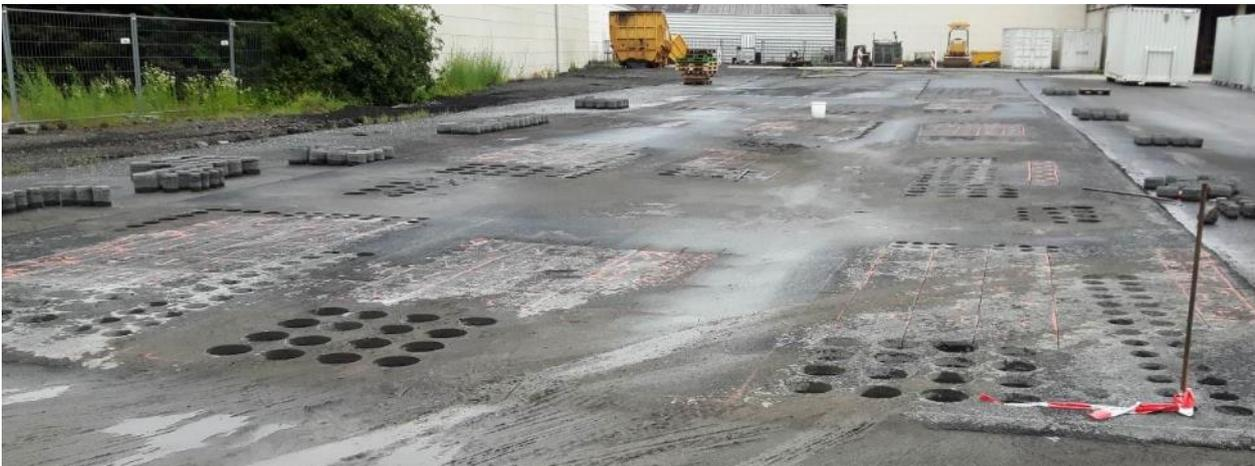
Bild 11: Probestrecke während der Probenentnahme
