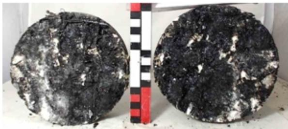
Bild 375: Beispiele der Gesteinszertrümmerung an der Deckschicht (links) und Binderschicht (rechts) des abgescherten Probekörpers, Strecke 1, Variante mE – unbelastet\_2.
