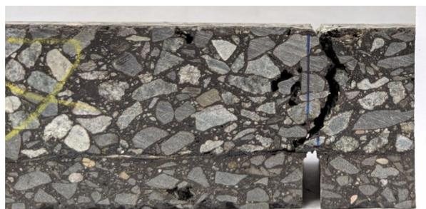
Bild 137: Typisches Rissbild bei durchgehendem Riss, Variante XI (Gitter), T = 10 °C, 1,5 kN, Unterlage 1 (weich).
