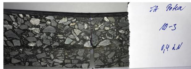
Bild 109: Variante X (Gitter) nach Versuchsende, Lastamplitude: 0,4 kN, Lastzyklen: ~12.000, Riss bis Mitte Probekörper.
