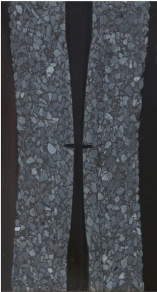
Bild 148: Probe IV a (ungefräst, Gitter) nach der Prüfung im Spurbildungsgerät. Dargestellt sind die Querschnitte der nach dem Versuch mittig in zwei Teile gesägten Platten.
