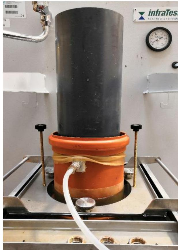
Bild 16: Prüfeinrichtung Durchlässigkeit
