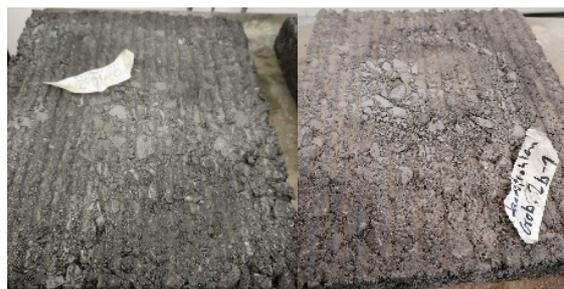
Bild 278: Beispiel für sandgestrahlte Oberflächen mit Simulation einer fein (links) und grob (rechts) gefrästen Oberfläche von Asphaltprobeplatten.
