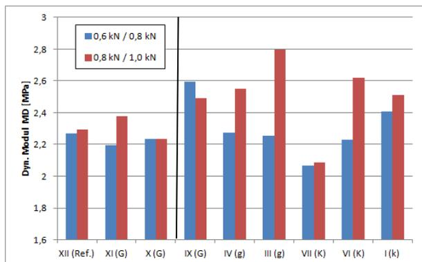
Bild 135: Dyn. Modul nach 50.000 Lastimpulsen für die Laststufen 0,6 kN und 0,8 kN (XIII, XI, X) bzw. 0,8 kN und 1,0 kN bei 1-Punkt-Biegeversuchen, Unterlage 2 (mittel).
