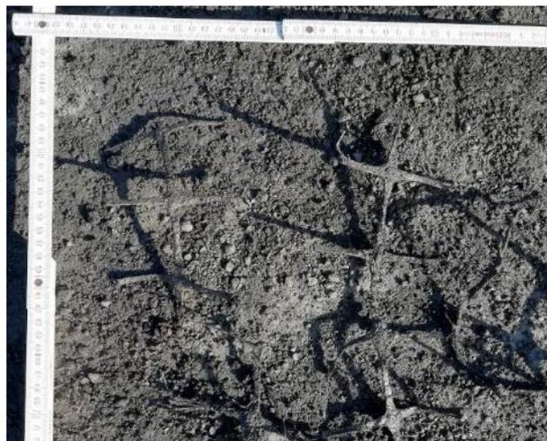
Bild 15: Teile einer Asphalteinlage im Fräsgut
