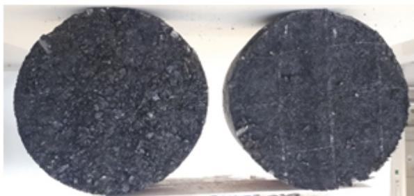
Bild 376: Beispiele für die Trennung an der Asphalteinlage, Deckschicht (links) und Binderschicht mit Asphalteinlage (rechts) des abgescherten Probekörpers, Strecke 2, Variante mE – belastet\_1.
