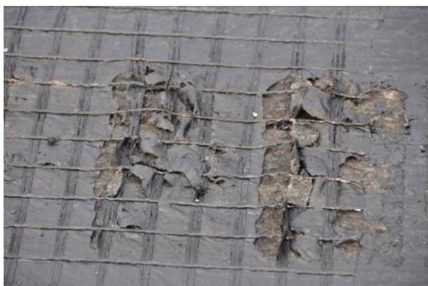
Bild 9: Gitter mit Verlegehilfe nach der Überfahrt
