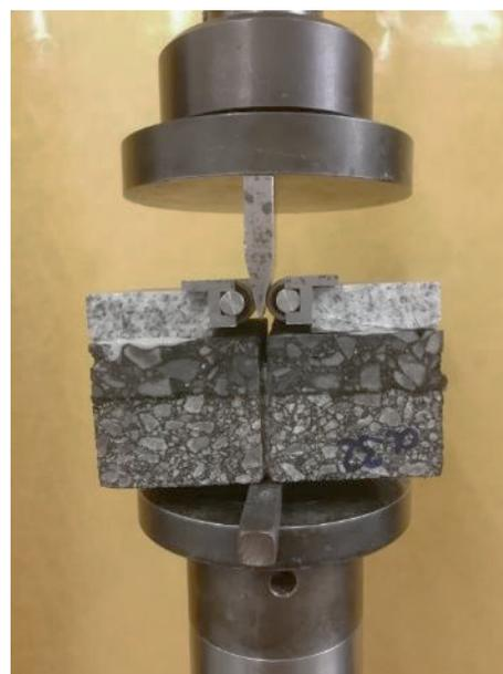
Bild 330: Versuchsaufbau des Keilspaltversuchs in der Universalprüfmaschine zu Beginn der Prüfung
