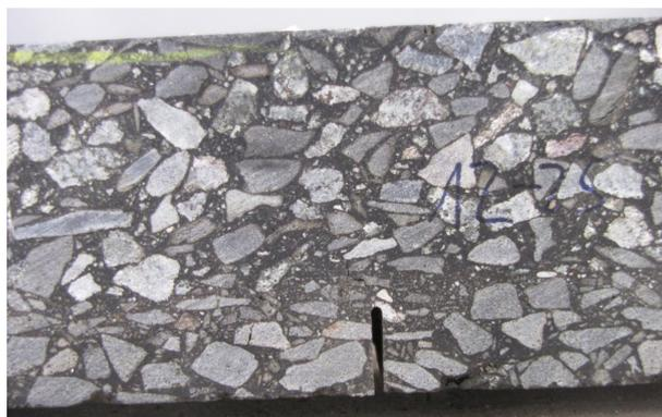
Bild 122: Rissbild am Probekörper XII-25 nach Prüfung, Dehnungsamplitude  $200 \mu\text{m}/\text{m}$ ,  $N_{f50} = 55.602$ , Riss durch die Schichtgrenze.
