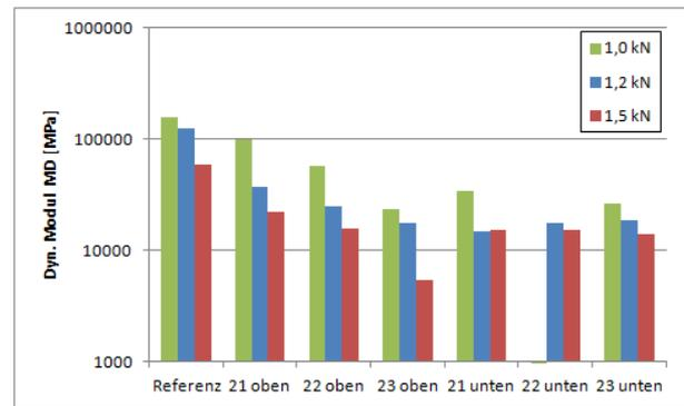
Bild 171: Dyn. Moduln nach 50.000 Lastimpulsen ohne elast. Verformung der Unterlage in Abhängigkeit der Last bei 1-Punkt-Biegeversuchen, Referenz und Gittervarianten.
