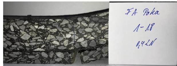
Bild 105: Variante I (Gitter) nach Versuchsende, Lastamplitude: 0,4 kN, Lastzyklen: ~201.000, kein Riss.
