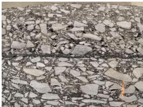
Bild 368: Bohrkern L3079 - Hohlraumreiche Binderschicht
