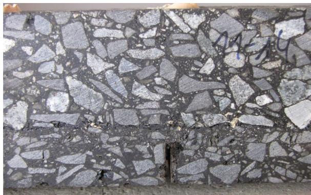
Bild 123: Rissbild am Probekörper XI-14 nach Prüfung, Dehnungsamplitude  $275 \mu\text{m}/\text{m}$ ,  $N_{f50} = 52.502$ , Riss bis zur Schichtgrenze, wandert an der Einlage entlang.
