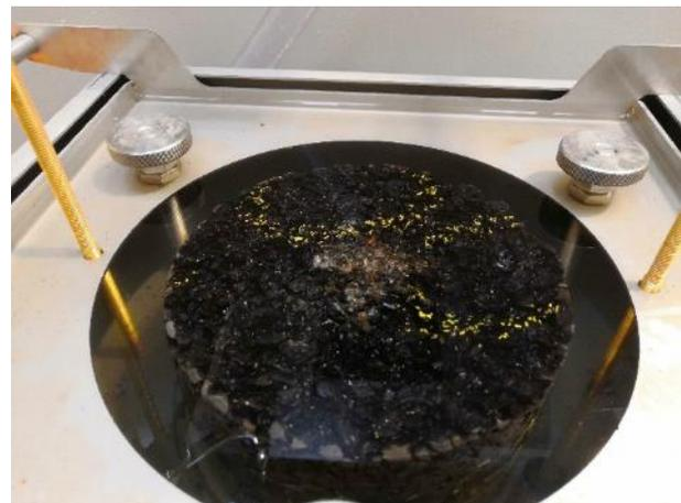
Bild 17: Probekörper während der Wassersättigung vor Prüfung der Durchlässigkeit
