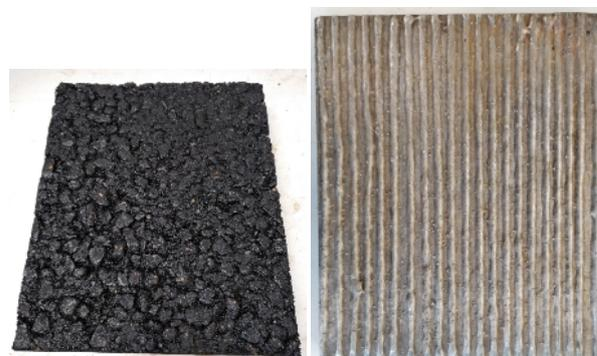
Bild 276: Nicht bearbeitete Oberfläche als Standard (links) und Negativform für die Simulation einer gefrästen Oberfläche zum Einlegen in den Walzsektor-Verdichter (rechts).
