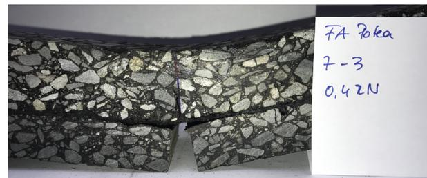
Bild 106: Variante VII (Kombiprodukt) nach Versuchsende, Lastamplitude: 0,4 kN, Lastzyklen: ~47.000, Riss bis Mitte Probekörper.
