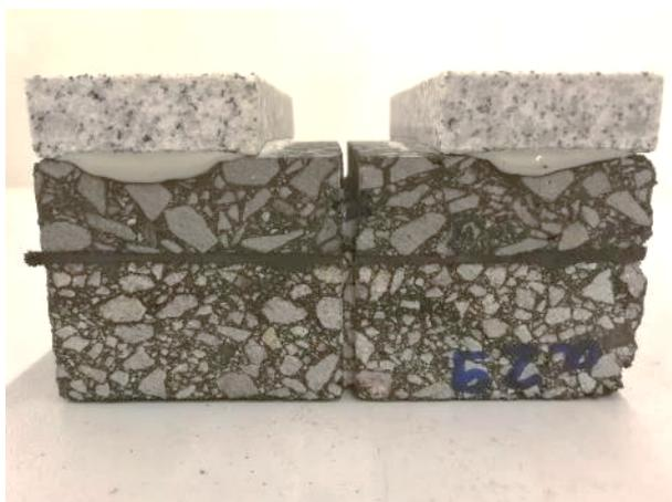
Bild 279: Fertig präparierter Probekörper mit Natursteinblöcken und Schlitzung; mit deutlich sichtbarer Asphalteinlage zwischen Deckschicht (unten) und Binderschicht (oben)
