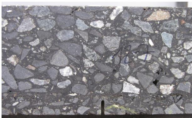
Bild 121: Rissbild am Probekörper XII-7 nach Prüfung, Dehnungsamplitude  $300 \mu\text{m}/\text{m}$ ,  $N_{f50} = 16.560$ , kleiner Riss bis zur Schichtgrenze.
