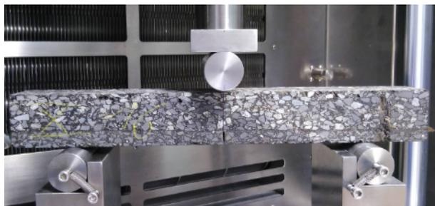
Bild 309: Prüfrahmen für zyklische 3-Punkt-Biege-Prüfungen.
