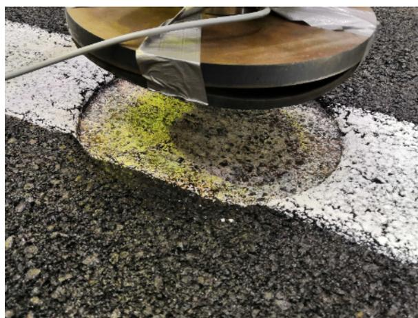
Bild 188: Verformungen unter Lasteinleitungsplatte
