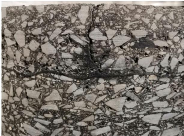
Bild 366: Riss in Bohrkern mit Durchmesser 400mm
