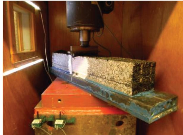
Bild 124: Versuchsaufbau für 3-Punkt-Biegeversuche auf elastischer Unterlage nach (Vismara et al. 2012a).
