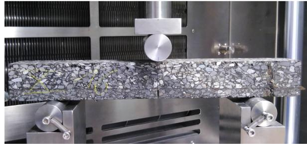
Bild 92: Prüfrahmen für zyklische 3-Punkt-Biege-Prüfungen.
