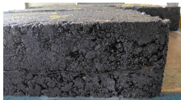
Bild 163: Beispiel für hergestellte Asphalt-Probepplatte zur Prüfung der bewehrenden Funktion von Asphalteinlagen.
