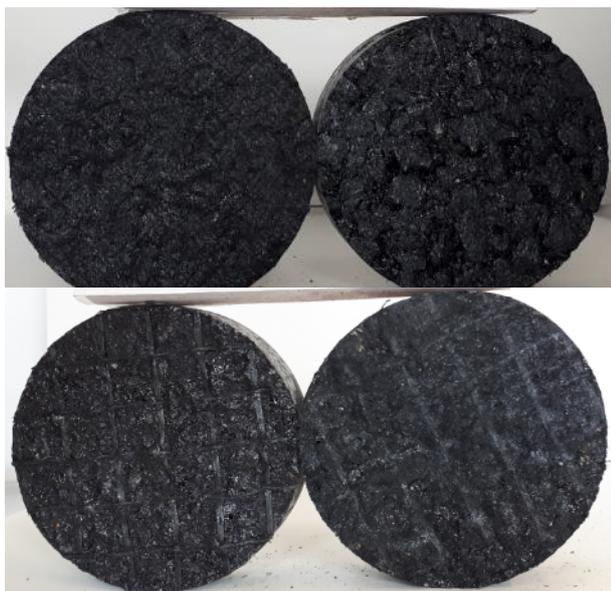
Bild 296: Beispiele des Ablösens der Einlagen, Deckschicht (links) und Binderschicht (rechts) der abgesicherten Probestkörper, Varianten 2-0 (oben) und 7-0 (unten).
