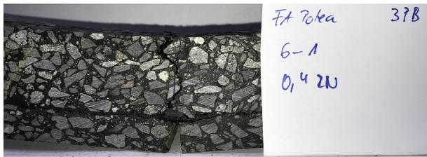
Bild 110: Variante VI (Kombiprodukt) nach Versuchsende, Lastamplitude: 0,4 kN, Lastzyklen: ~192.000, durchgängiger Riss.
