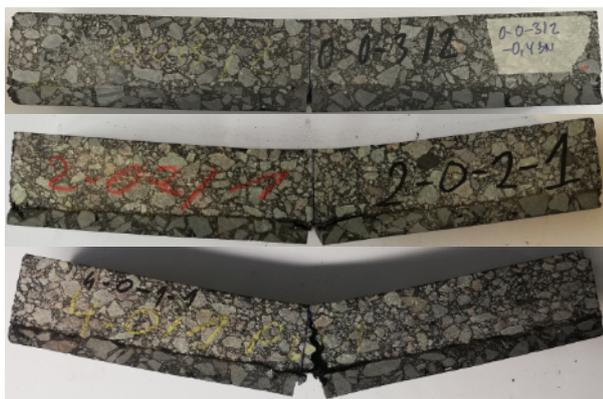
Bild 315: Probekörper der Varianten 0-0 (oben) 2-0 (mittig) und 4-0 (unten) nach Versuchsende des 3-Punkt-Biegeversuchs bei einer Lastamplitude von 0,4 kN.
