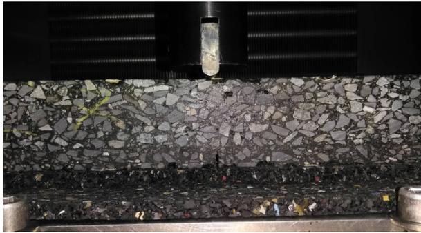
Bild 126: Prinzipieller Versuchsaufbau für 3-Punkt-Biegeversuche auf elastischer Unterlage.
