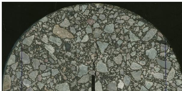
Bild 236: Rissweg während eines Halbzyylinderbiegeversuchs bei einer Temperatur von -6 °C.
