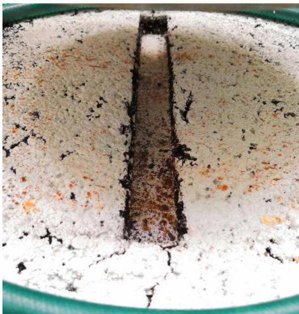
Bild 189: Verformungen des Asphaltes und Rissdurchschlag an der Referenzfläche
