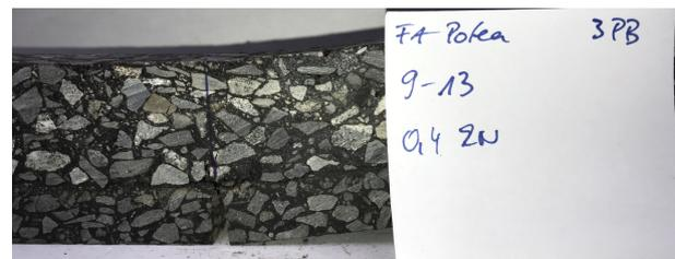
Bild 108: Variante IX (Gitter) nach Versuchsende, Lastamplitude: 0,4 kN, Lastzyklen: ~250.000, Riss bis oberes Drittel des Probekörpers.
