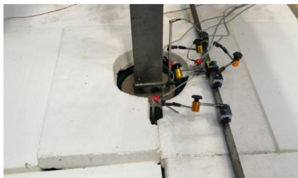
Bild 190: Isolierung der Testfläche
