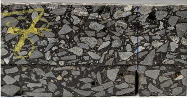
Bild 138: Typisches Rissbild bei nicht durchgehendem Riss und starken Ablösungen an der Einlage, Variante III (Gitter),  $T = 10\text{ °C}$ , 1,5 kN, Unterlage 1 (weich).
