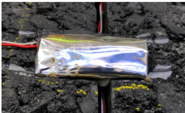
Bild 186: mechanischer Schutz DMS (Abdeckband)
