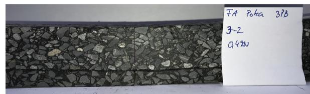
Bild 107: Variante III (Gitter) nach Versuchsende, Lastamplitude: 0,4 kN, Lastzyklen: ~250.000, kein Riss.
