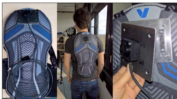
Bild 3-13: Rückenprotector mit Beschleunigungssensor
