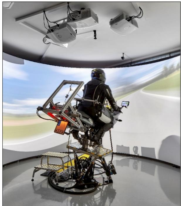
Bild 3-16: DESMORI Motorrad-Fahrsimulator
