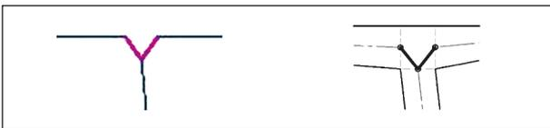
Bild 3-23: Kopplung zwischen Fahrbahnplatte und Steg im jeweiligen Anschnitt
