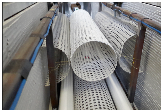
Bild 43: Innenaufbau des Prototypreaktors 2 mit beschichtetem, röhrenförmiger Glasfaserarmierung und Faserzementplatten am Rand (nicht alle Röhren und UV-Lampen eingebaut)
