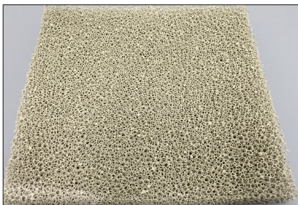
Bild 33: 675 cm 2 Schaumprobe, ungelocht, 5 ppi, 3 cm dick, beschichtet mit 75 M.-% Zusatzstoff E/25 M.-% Zement-Mischung
