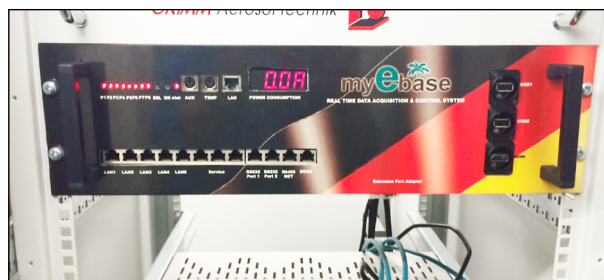
Bild 133: Datenkommunikationssystem „myEbase“: Frontansicht
