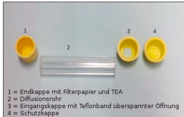
Bild 121: Bestandteile der Passivsammler
