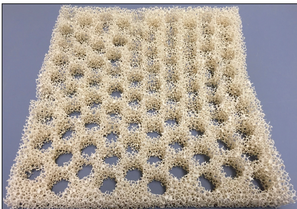
Bild 30: 675 cm 2 Schaumprobe, 90 Löcher, 5 ppi, 3 cm dick, beschichtet mit der Farbe C
