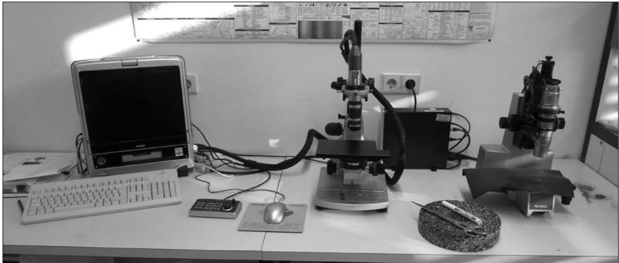
Bild 25: Digitalmikroskop (v. l.: Steuerungscomputer, Stativ 1, Stativ 2 mit Profilmesseinheit)
