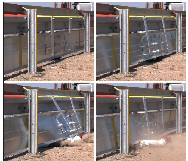
Bild 82 Durchrutschen des Arms bei Anprall zwischen den Pfosten, Versuch SH 19.61
