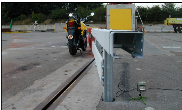
Bild 7 Im Forschungsprojekt entwickelte passive Schutz-einrichtung „Schweizer Kastenprofil mit Unterzug“
