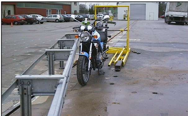
Bild 1 Versuch SH 99.05 – aufrechter Anprall an EDSP
