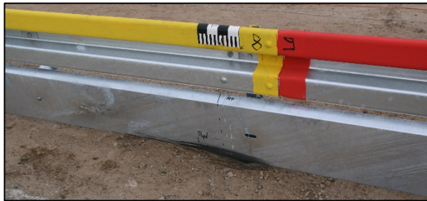
Bild 35 Vorderseite der Schutzeinrichtung und Anprallpunkt nach dem Versuch
