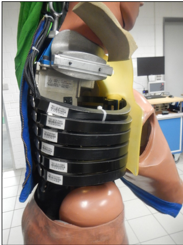
Bild 37 "Gebrochene" Schulter und beschädigtes Rippenpaket
