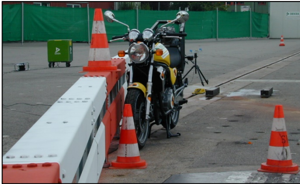
Bild 6 Versuch SH 99.80 – aufrechter Anprall an „Schweizer Kastenprofil mit Unterzug“
