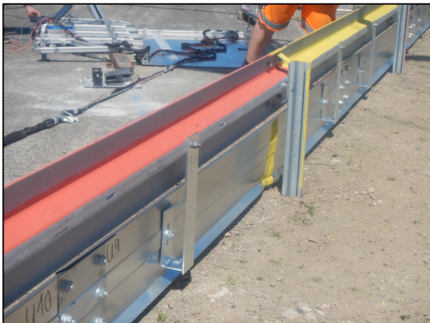
Bild 63 Rückseite der Schutzeinrichtung nach dem Versuch
