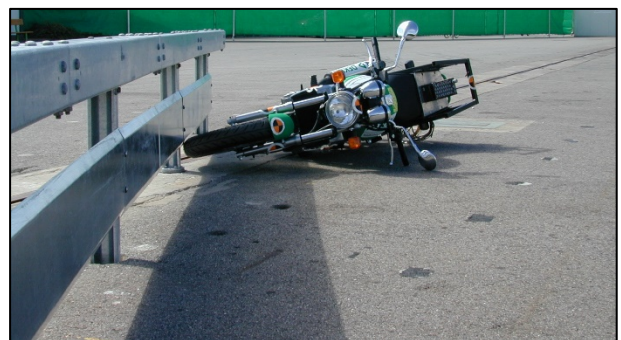
Bild 5 Versuch SH 99.79 – rutschender Anprall an „Schweizer Kastenprofil mit Unterzug“
