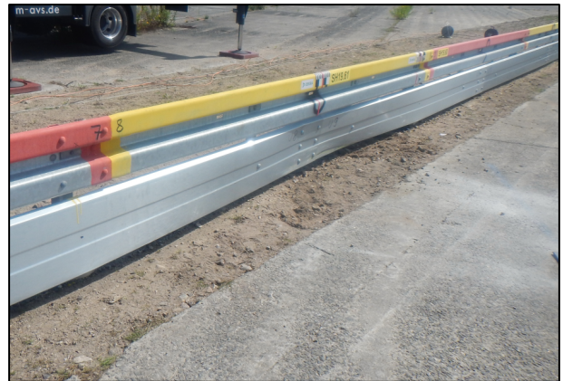
Bild 72 Vorderseite der Schutzeinrichtung nach dem Versuch
