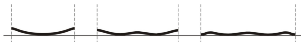
Bild 3.23: Konkave Verformung bei Austrocknung (Schwinden) von oben, sowie Verformung bei nachfolgender Erwärmung [RDO Beton 09]
