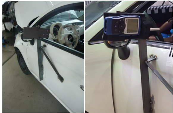
Bild 5-16: Gestell zur Aufnahme des Akustikmessgerätes an der Fahrertür des Fiat 500
