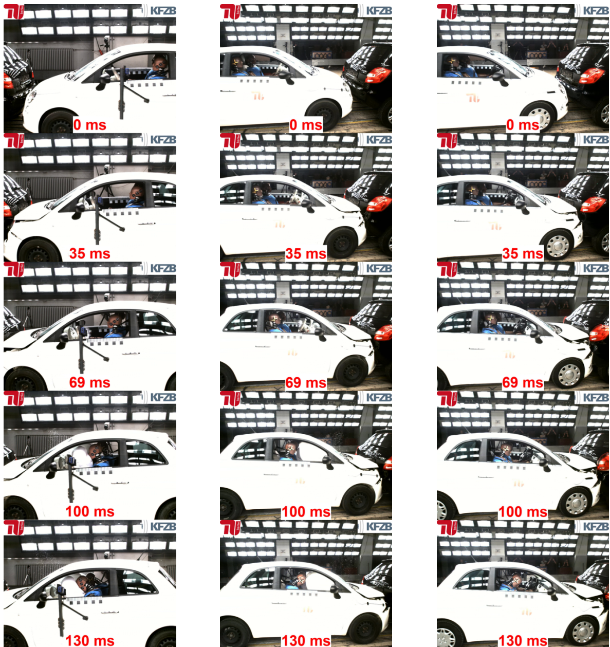
Bild 5-19: Versuchsablauf der Unfallrekonstruktionen mit dem Fiat 500: Fahrerseite mit Airbagzündung (links), Beifahrerseite mit Airbagzündung (mitte) und Beifahrerseite ohne Airbagzündung (rechts)
