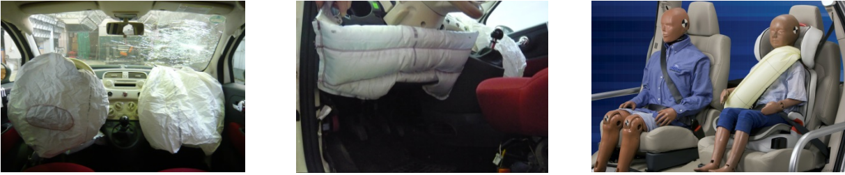
Bild 2-2: Beispiele für Airbags: Links: Frontairbags, Mitte: Knieairbag, Rechts: Beltbag [FORD MOTOR COMPANY, 2013]
