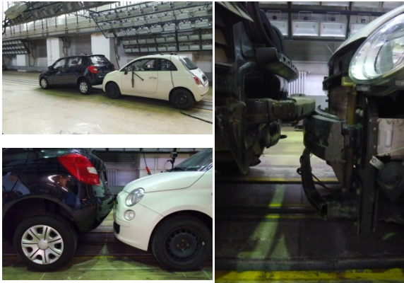
Bild 5-15: Fahrwerksmanipulation am Skoda Fabia zur Darstellung des Bremsnickens beider Fahrzeuge
