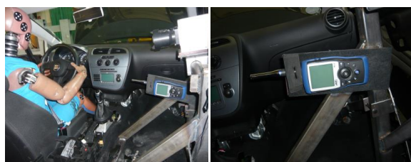
Bild 5-4: Aufbau der akustischen Innenraummessung
