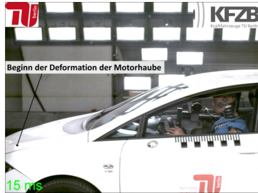
Bild 5-28: 15 ms nach Pfahlkontakt ist eine Deformation der Motorhaube sichtbar, Schallpegel im Innenraum des Fahrzeugs erreicht bereits 134 dB, der Stapediusreflex löst aus
