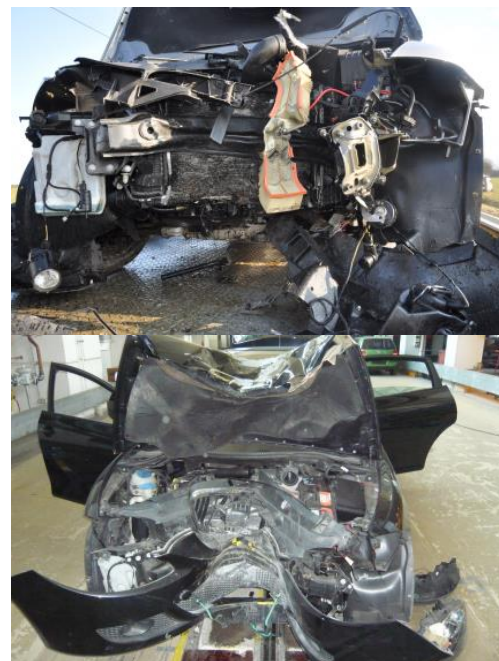
Bild 5-8: Querträger wurde vom Längsträger auf der Fahrerseite abgerissen
