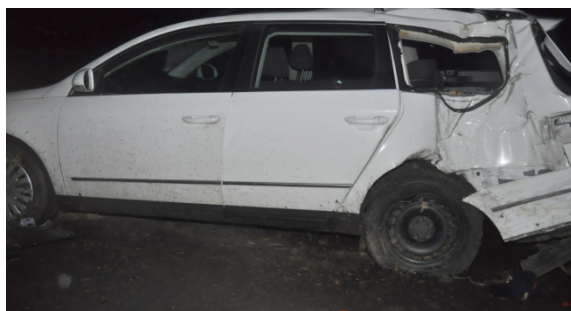
Bild 4-17: Deformationsbild beim Fall mit MAIS 3+ Verletzung ohne Seitenairbagauslösung
