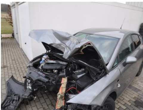
Bild 5-6: Vergleich der Schadensbilder zwischen Unfallfahrzeug und Fahrzeug nach der Unfallrekonstruktion (Frontansicht)
