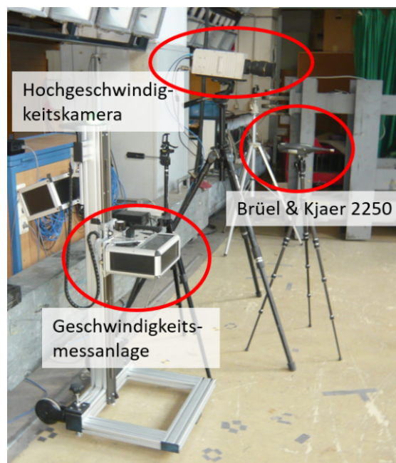
Bild 5-24: Positionierung des B&K Schallpegelmessers als Kontrollinstrument in 3,5 m Abstand zum Fahrzeug
