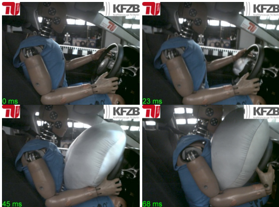
Bild 5-11: Vergleich der Interaktion zwischen Dummy und Airbag bei der Unfallrekonstruktion mit dem Seat Leon bei unterschiedlichen Zündzeitpunkten (oben: Zündzeitpunkt vom fahrzeugeigenem Steuergerät bei ca. 40 ms, unten: Zündung des Airbags bei 20 ms getriggert)
