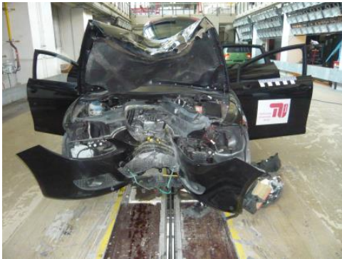
Bild 5-6: Vergleich der Schadensbilder zwischen Unfallfahrzeug und Fahrzeug nach der Unfallrekonstruktion (Frontansicht)
