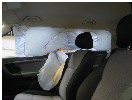
Bild 3-2: Beispiele für Seitenairbags. Seitenairbag entfaltet sich aus der Rückenlehne und der Vorhangairbag überdeckt die Fensterfront zwischen A- und C-Säule
