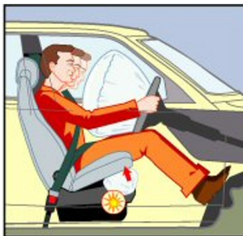
Bild 3-1: Funktionsweise eines Anti-sliding-Airbags [BIRCH, 2008]
