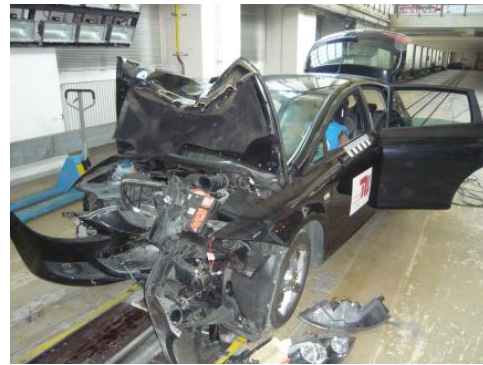
Bild 5-7: Vergleich der Schadensbilder zwischen Unfallfahrzeug und Fahrzeug nach der Unfallrekonstruktion (Schrägansicht)
