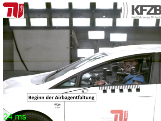
Bild 5-29: Bereits nach 24 ms beginnt die Airbagentfaltung mit Spitzenpegeln von bis zu 160 dB, der Stapediusreflex hatte damit 9 ms Zeit seine Wirkung aufzubauen
