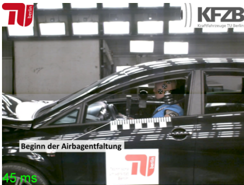
Bild 5-26: Nach 45 ms erfolgt Auslösung des Airbags, in der Folge entstehen Spitzenpegel von bis zu 160 dB, bezogen auf die Ohrposition des Dummys
