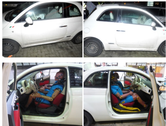
Bild 5-17: Sitzeinstellung und -position der Dummies im Vergleich zu Bildern vom Unfallfahrzeug
