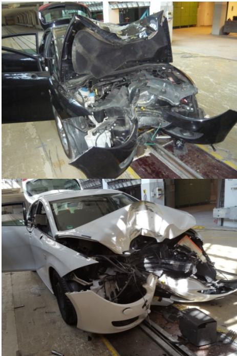
Bild 5-9: Vergleich der Schadensbilder beider Seat Leon nach der Unfallrekonstruktion
