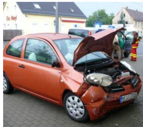
Bild 4-19: Beschädigungen Fall 2 Nissan Micra
