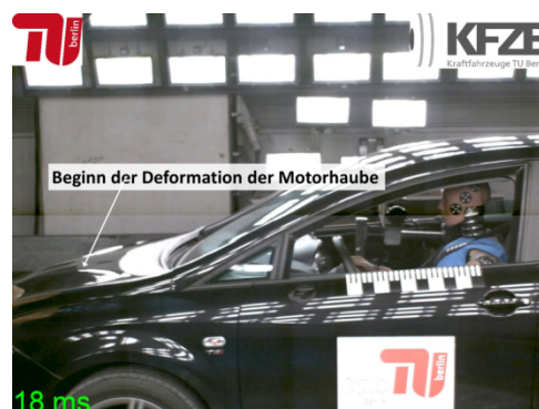
Bild 5-25: Deutlich sichtbare Deformation der Motorhaube, 18 ms nach Pfahlkontakt. Die Schallpegelmessungen im Fahrzeug zeigen hier bereits Werte oberhalb von 134 dB
