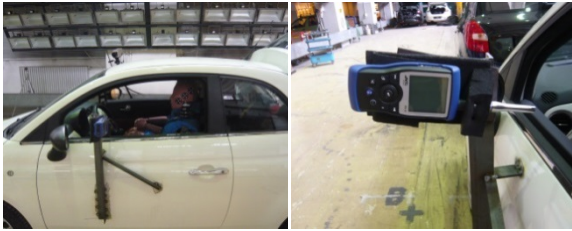
Bild 5-32: Anbringung des Schallpegelmessers, Mikrofonspitze 44 cm von der Lenkradmitte entfernt
