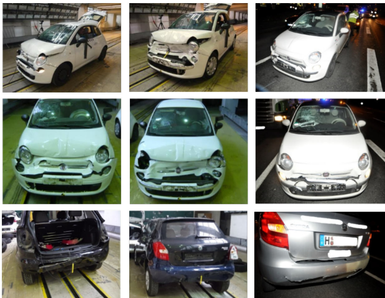
Bild 5-18: Vergleich der Schadensbilder zwischen den Fahrzeugen aus dem 1. Versuch (links), 2. Versuch (mitte) und Unfall (rechts)
