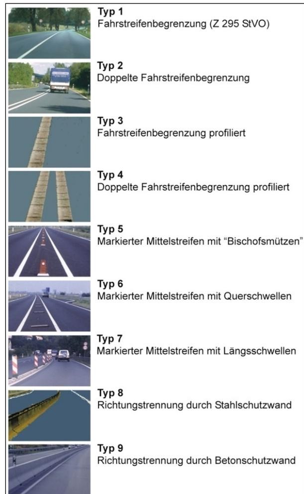
**Bild 2.24: Varianten von Fahrtrichtungstrennungen (LIPPOLD U. A., 2003)**
