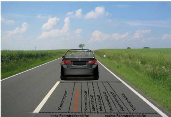
**Bild 4.19: Schematische Darstellung Abweichspur (Adler, 2010)**
