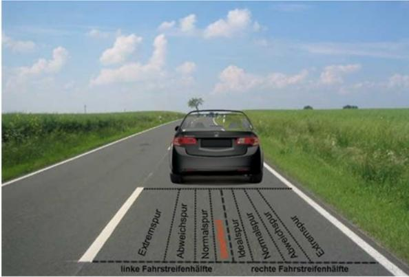
**Bild 4.17: Schematische Darstellung Idealspur (ADLER, 2010)**
