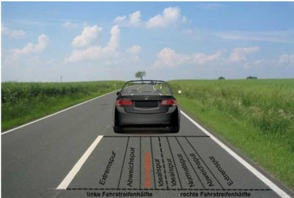
**Bild 4.18: Schematische Darstellung Normalspur (ADLER, 2010)**
