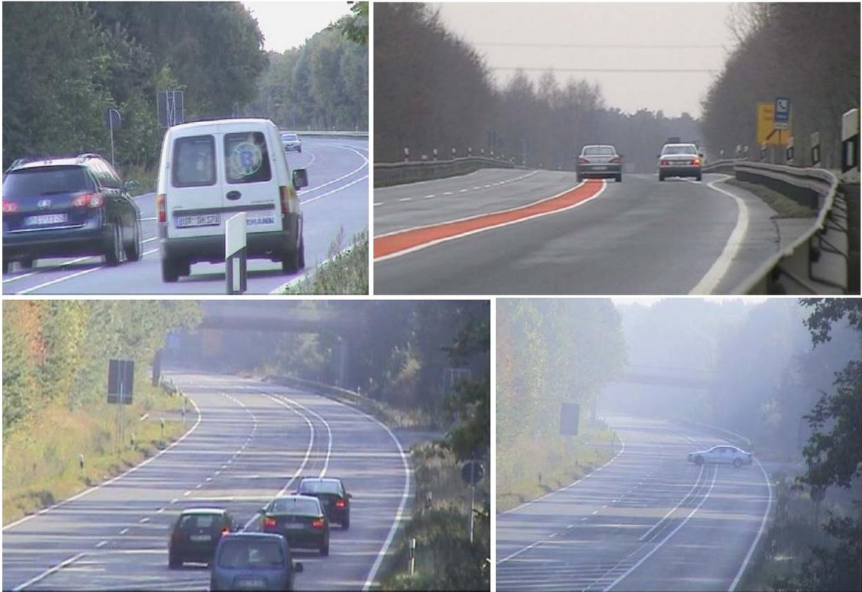
**Bild 5.26:** Beispiel von regelwidrigen Überfahrten der Fahrtrichtungstrennung B 67 anhand Videoanalysen (SCHOLLBACH 2009)
