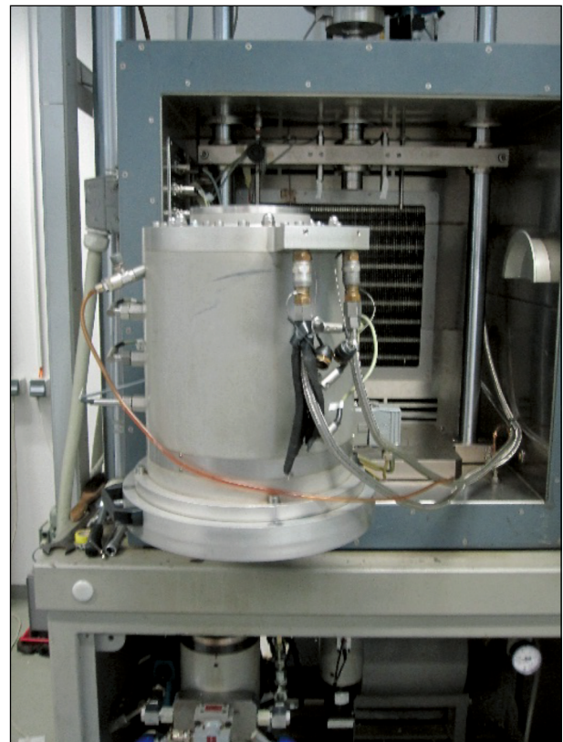
Bild 6-1: Triaxialzelle der TU Dresden
