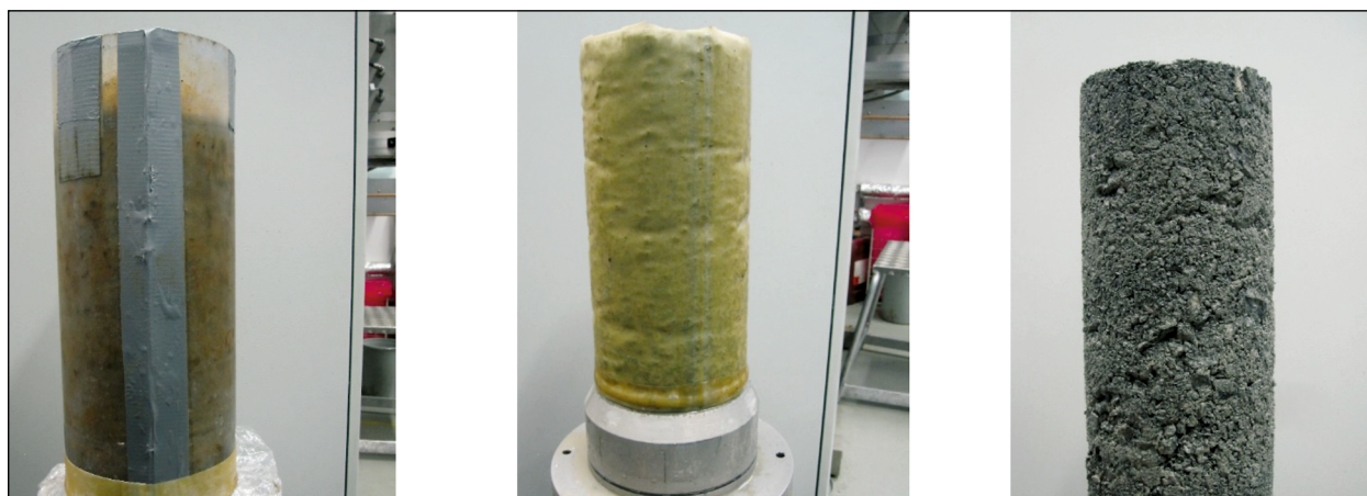
Bild 6-4: Probekörperherstellung – Links: Probekörper im Kunststoffzylinder, nach Entfernen der Stahlschalen, Mitte: Probekörper mit Gummimembran, Rechts: vollständig ausgeschalteter Probekörper nach Versuchsdurchführung (Diabas)
