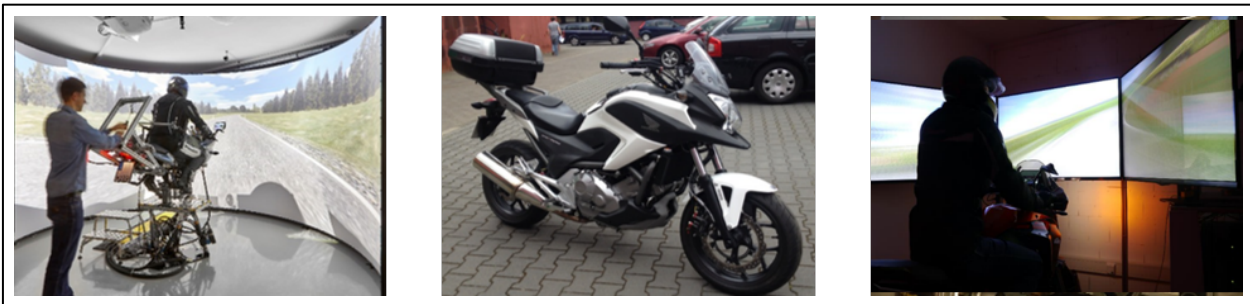
Bild 4-1: Dynamischer „DESMORI“-Simulator (links), Honda NC700X mit Messtechnik (Mitte),
