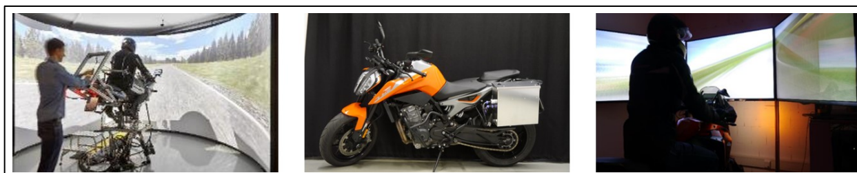
Bild 5-1: Dynamischer DESMORI-Motorrad-Simulator (links), KTM 790 Duke mit Messtechnik (Mitte), statischer Motorrad-Simulator der WIVW GmbH (rechts).
