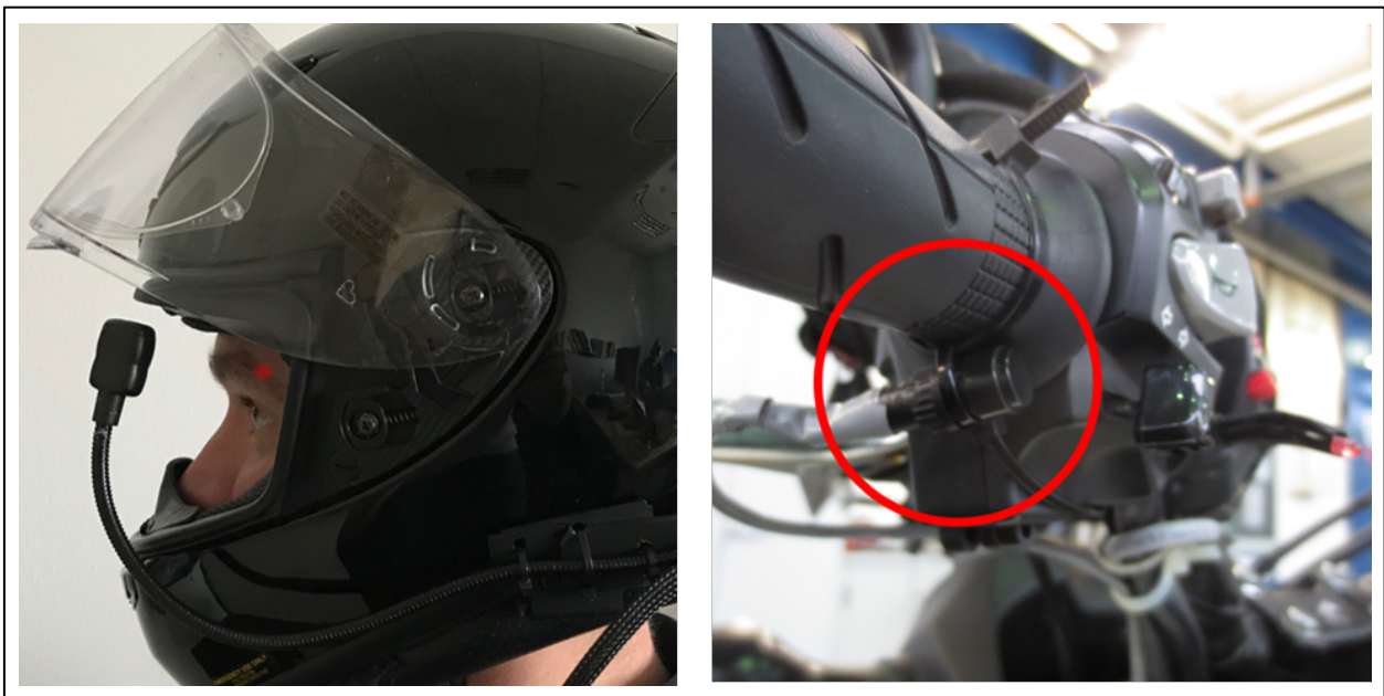
Bild 4-6: Links: Darstellung der Vorrichtung, die für den PDT verwendet wurde. Der rote Punkt stellt die Position dar, auf die die LED eingestellt wurde, um die Ergebnisse zwischen den Fahrern vergleichbar zu machen. Rechts: Taster am linken Lenkerende der HONDA NC700X, der für die Bestätigung der Signalwahrnehmung verwendet werden sollte.
