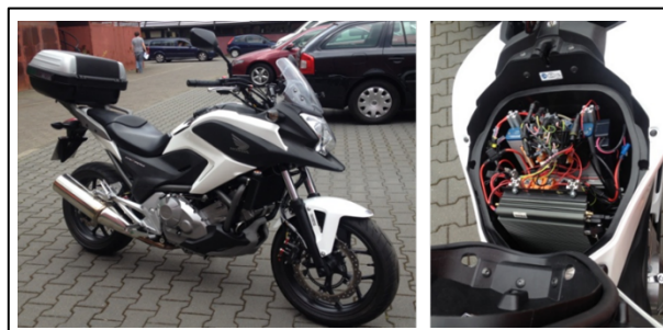
Bild 4-2: Honda NC700X (links); Detailaufnahme der Messtechnik im Helmfach (rechts).
