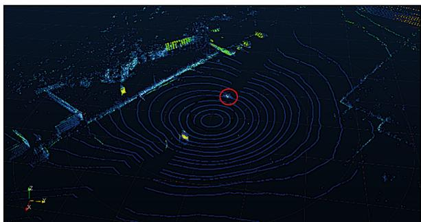
Bild 3-9: Beispielhafte Darstellung einer Rohdaten Lidar Aufnahme eines vorbeifahrenden Motorrades (roter Kreis)
