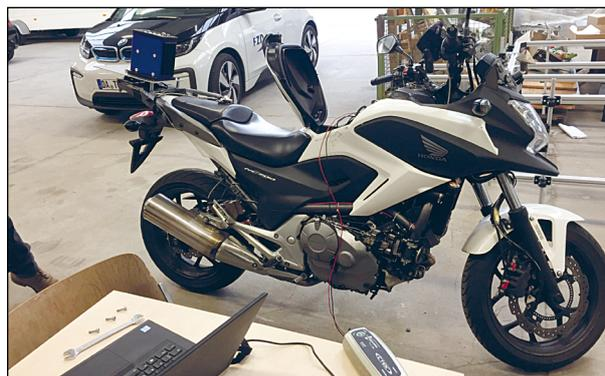
Bild 3-4: Messmotorrad Honda NC 700X
