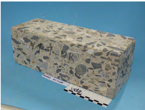
Bild 67 Prisma N1-1-UR vor der Prüfung
