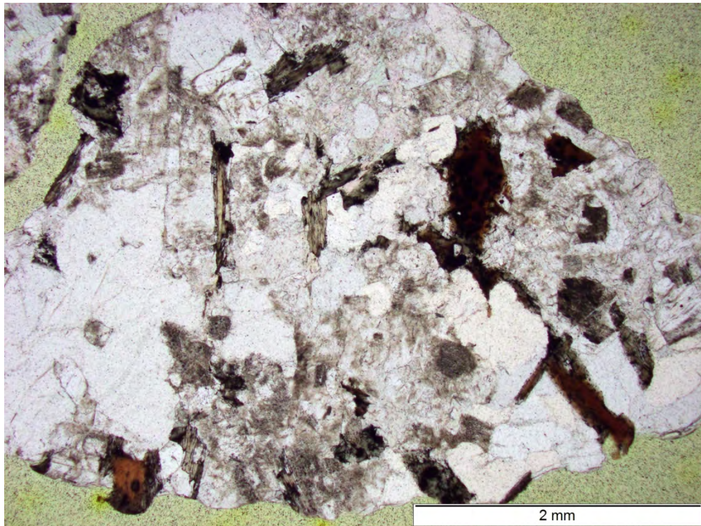
Bild 189 Streupräparat von Granit Neustift; Aufnahme in polarisiertem Licht
