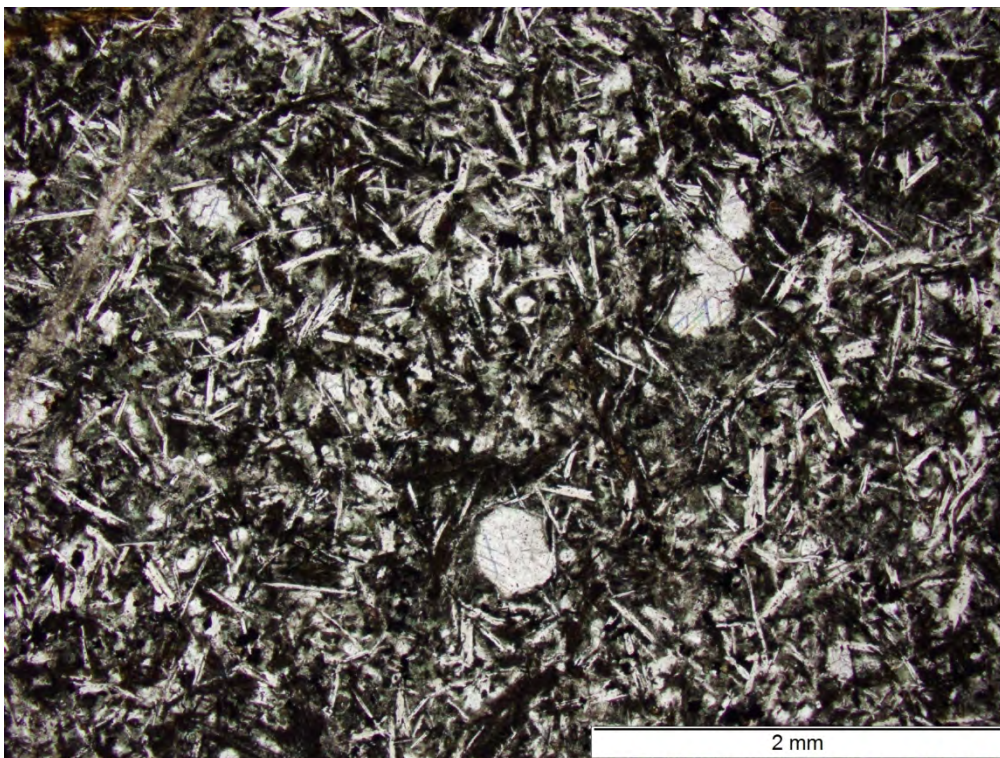
Bild 128 Beton N1 im Ausgangszustand; Diabas mit feinkristalliner Matrix; Aufnahme in polarisiertem Licht
