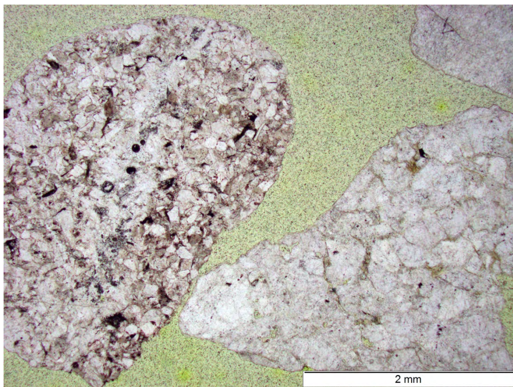
Bild 181 Streupräparat von Kies Moosburg; Kieskörner aus Sandstein; Aufnahme in polarisiertem Licht
