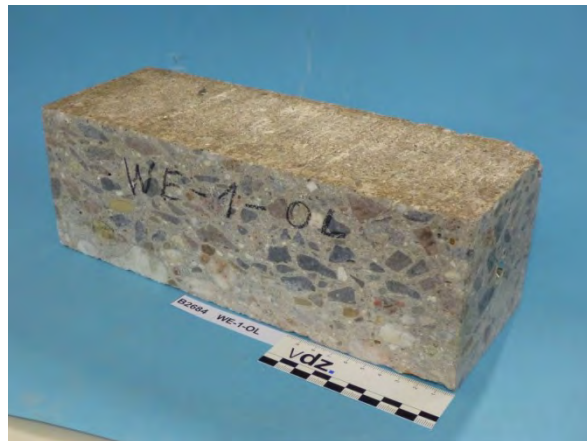
Bild 76 Prisma WE-1-OL vor der Prüfung
