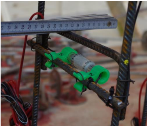
Abbildung 8: Links: Montage der Transducer mittels maßgefertigter Clips im Bewehrungskorb (hier: DLT 1.1, Transducer 2). Rechts: Träger DLT 1.4, Transducer 1, 2, 5, und 6.
