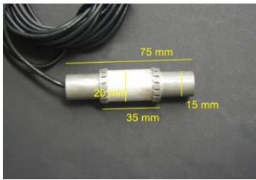
Abbildung 1: Der Ultraschall-Transducer ACS S0807.
